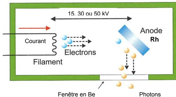
Figure II-13 : Représentation schématique du tube à rayons X
