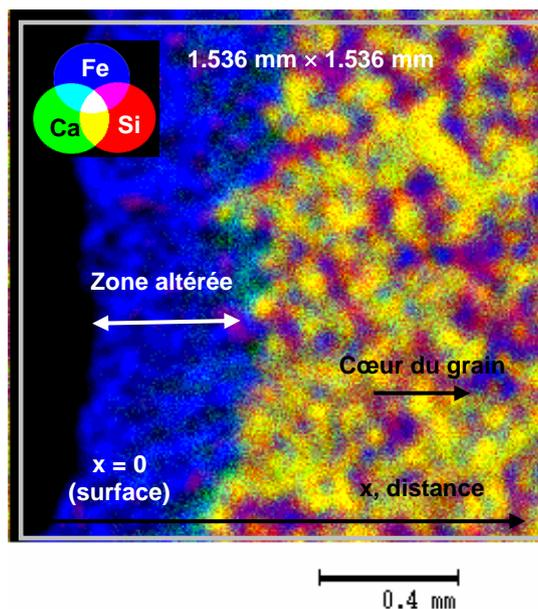
Figure IV-20 : Cartographie tricolore combinant les cartographies élémentaires du Si, du Ca et du Fe d'une section d'un grain de laitier LAC lixivié 130 jours en CTG-Leachcrete (paramètres d'enregistrement de la carte : faisceau de 10  $\mu\text{m}$ , 15 kV, temps de comptage  $1.66 \times 10^5$  s).
