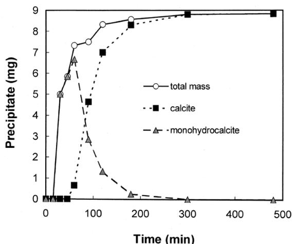
Figure IV-30 : Précipitation de Monohydrocalcite et de Calcite en fonction du temps (130)
