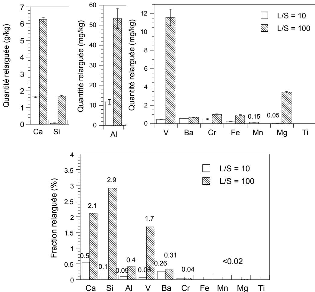
Figure III-4 : Quantités relarguées (g(mg)/kg LAC) et fractions totales relarguées (%) après 15 jours de lixiviation statique des laitiers LAC à rapport L/S 10 et 100
