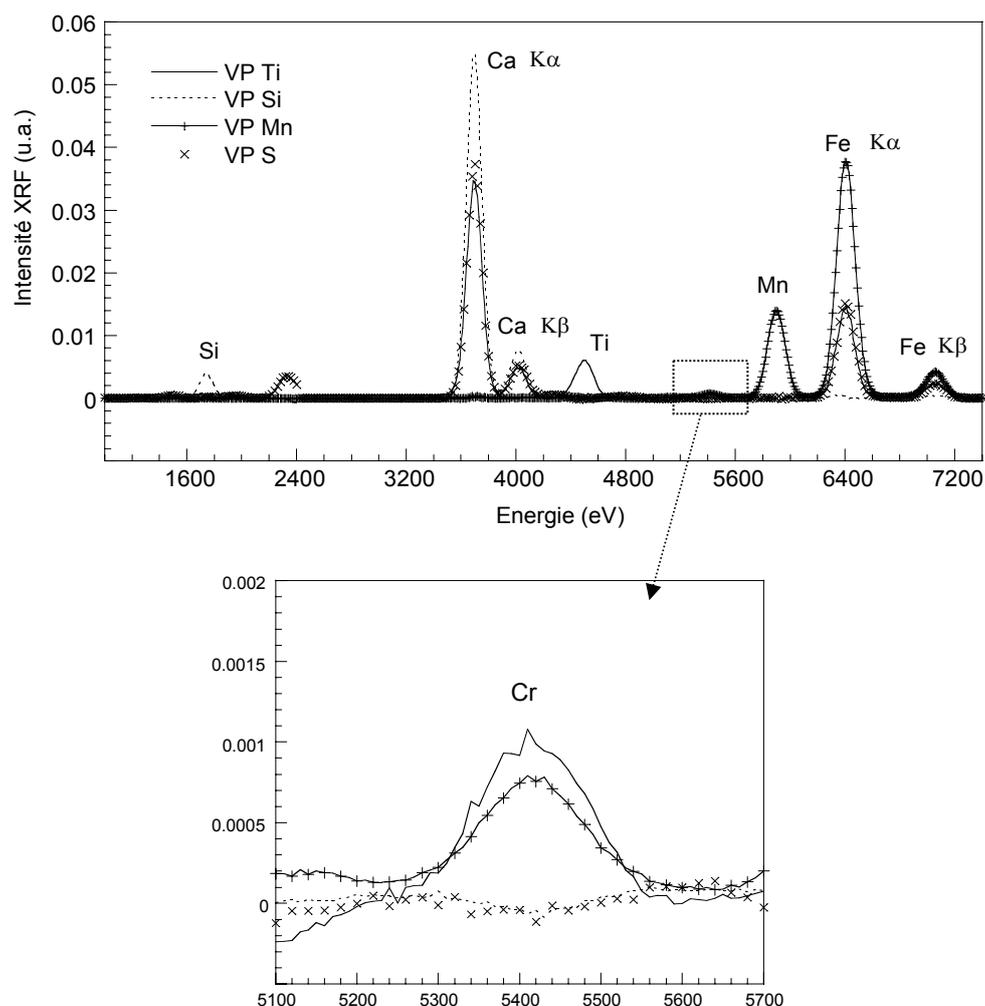
Figure V-6 : Spectres  $\mu$ -XRF extraits par l'analyse SIMPLISMA (voir Figure IV-10). La correspondance entre les « variable pure » (VP) et les phases minéralogiques est rappelée dans le Tableau V-4.
