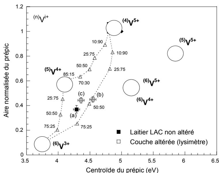
Figure V-33 : Evolution du degré d'oxydation et de la symétrie du V au cours de l'altération en lysimètre ( $n$ , symétrie et  $i$ , valence du V) (a) Laitier LAC non altéré, (b, c) Couche altérée d'un grain de laitier LAC vieilli 637 jours en lysimètre.
