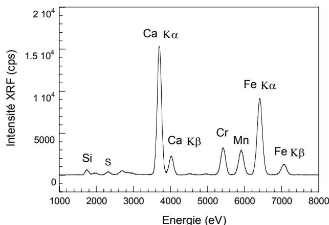
Figure V-16 : Spectre  $\mu$ -XRF (faisceau de 10  $\mu$ m, 1000s, 30 kV) enregistré dans une zone riche en Cr (ROI 1) de la zone altérée d'un grain de laitier LAC vieilli en lysimètre (voir Figure V-14)
