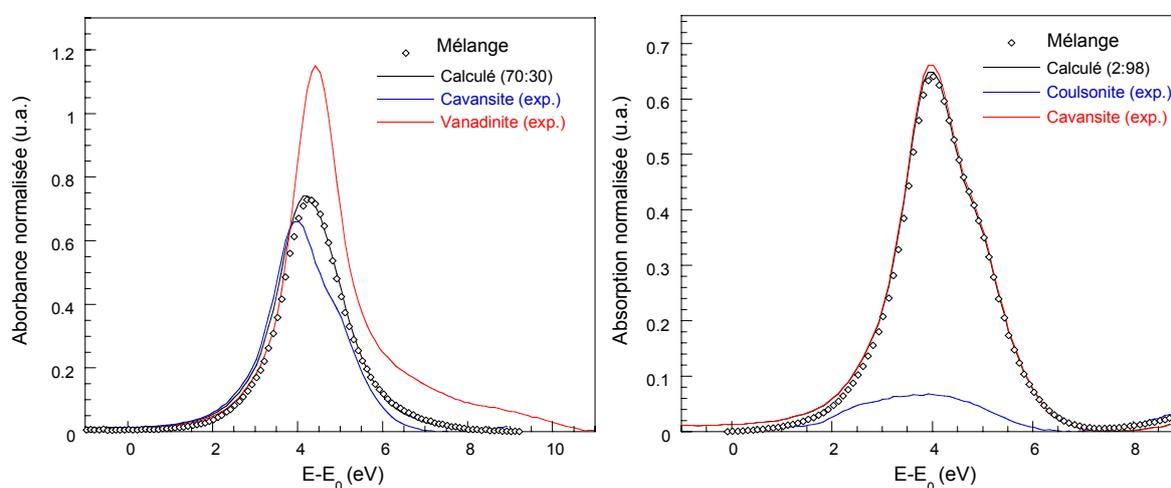
Figure II-22 : Combinaisons linéaires (Calculé) entre les précipités de la Cavansite et de la Vanadinite et ceux de la Coulsonite et de la Cavansite (extraits des spectres expérimentaux (exp.)). Les combinaisons linéaires sont comparées au précipité d'un mélange comprenant 70% molaire de Cavansite et 10% molaire de Vanadinite et d'un mélange comprenant 2 % molaire de Coulsonite et 98 % molaire de Cavansite (Mélange).
