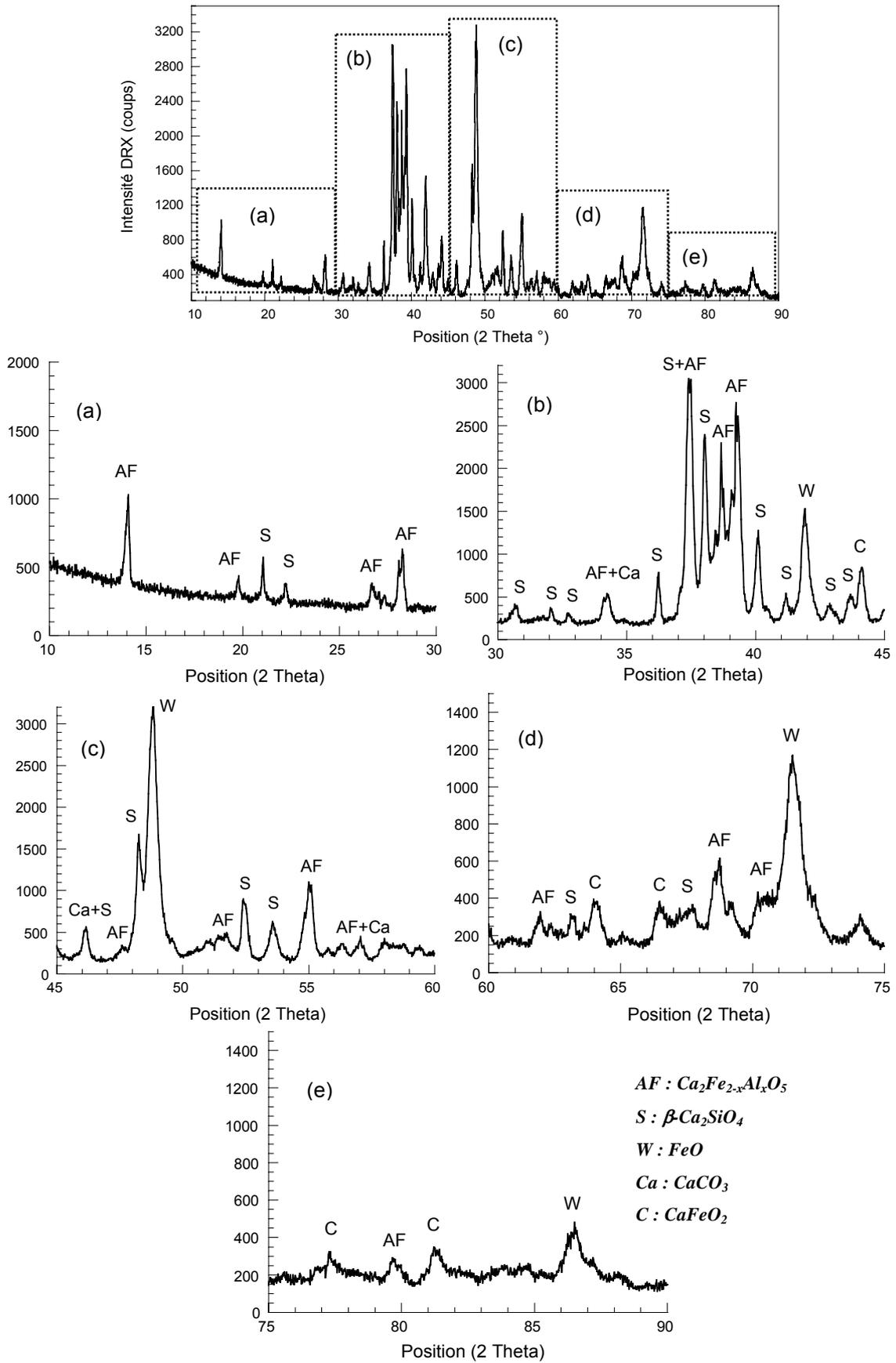
Figure IV-1 : Diffractogramme du laitier LAC (> 2 mm)
