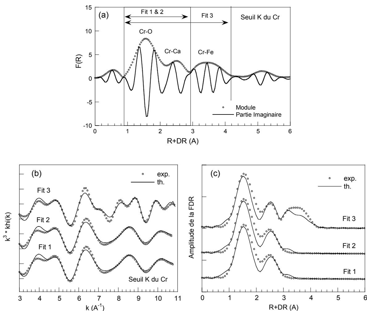
Figure V-9 : (a) Pseudo fonction de distribution radiale (module et partie imaginaire) et (b, c) ajustements des spectres EXAFS partiels des filtres  $[0.81-2.88 \text{ \AA}]$  et  $[0.81-4.13 \text{ \AA}]$  (fit 1, 2 & 3)
