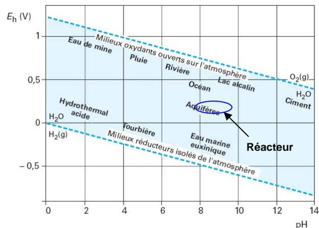
Figure II-8 : Diagramme de Pourbaix précisant le domaine pH-Eh dans le réacteur et les limites de stabilité de l'eau (48)
