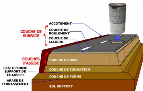
Figure I-3 : Structure des chaussées : terminologie
