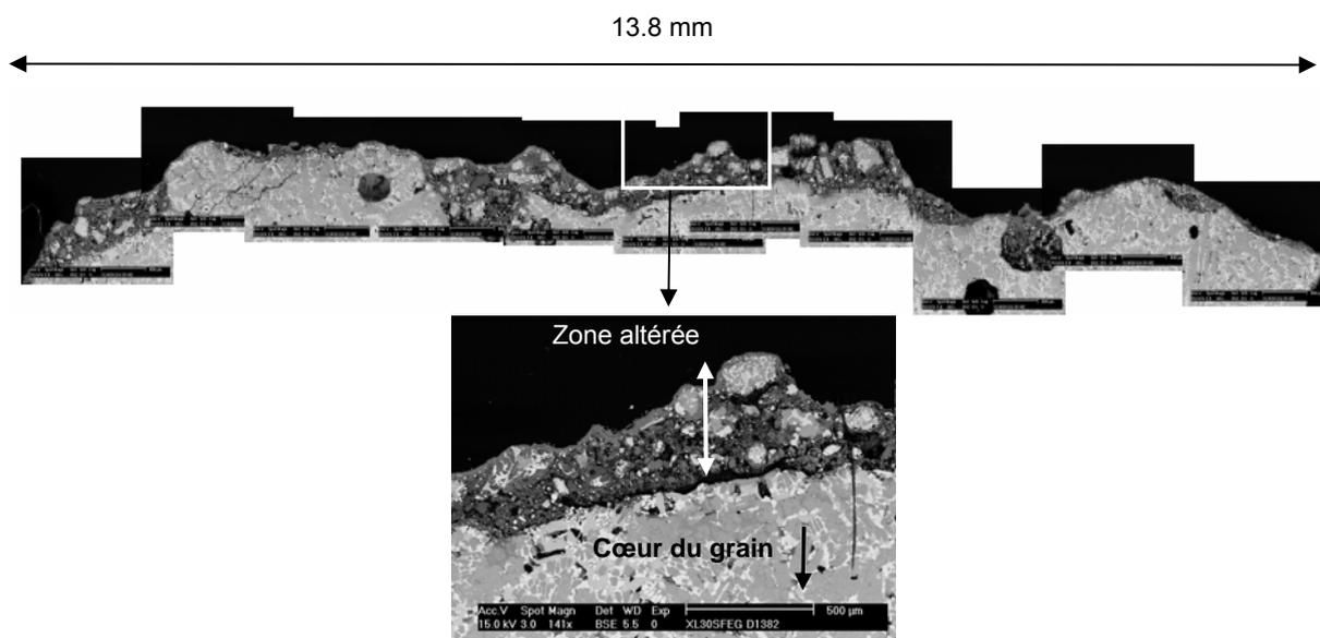
Figure IV-22 : Observation au MEB (mode BSE) d'une section polie d'un grain de laitier LAC vieilli en lysimètre.
