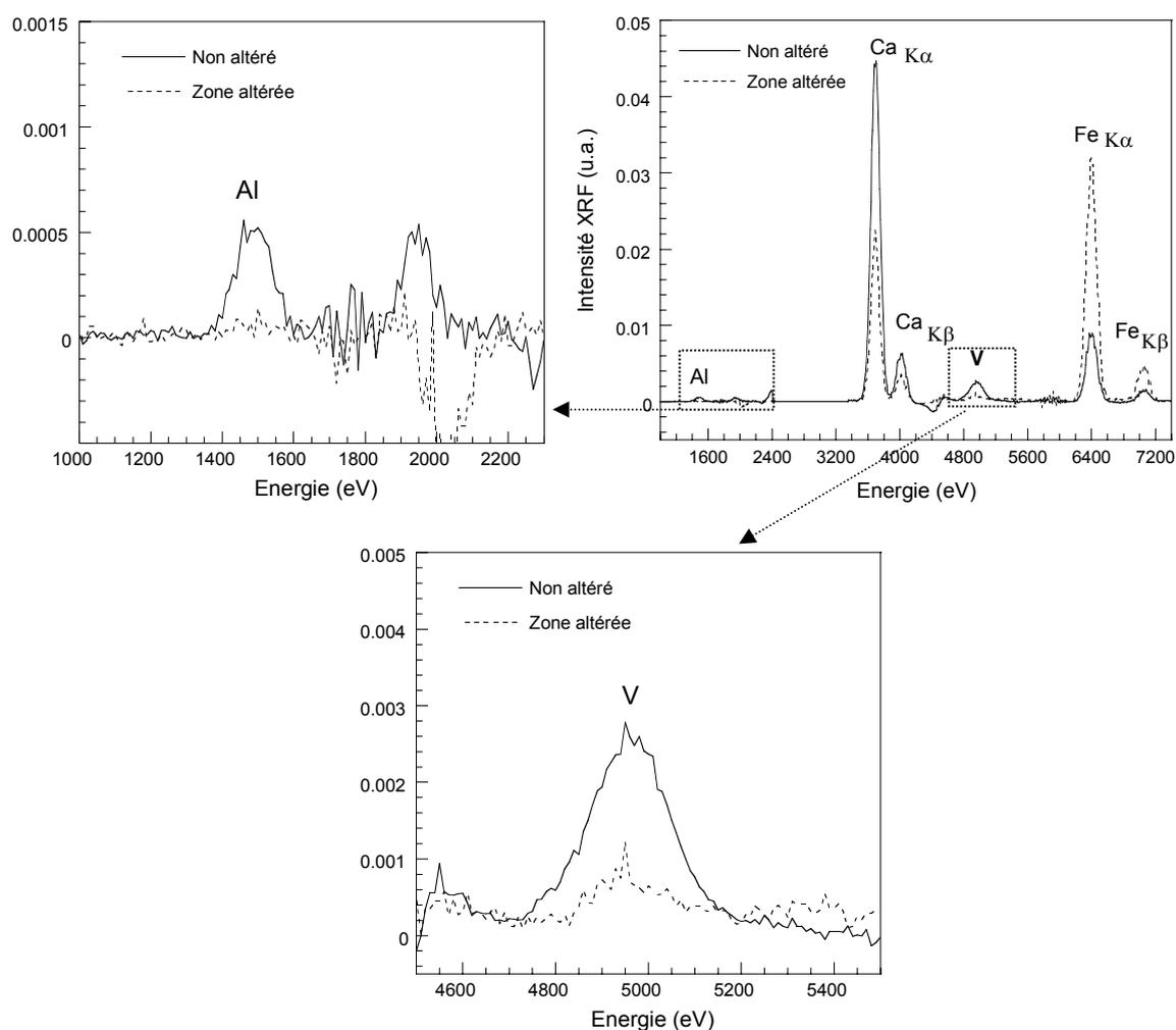
Figure V-37 : Spectres  $\mu$ -XRF extraits par l'analyse SIMPLISMA à partir de la « variable pure V »
