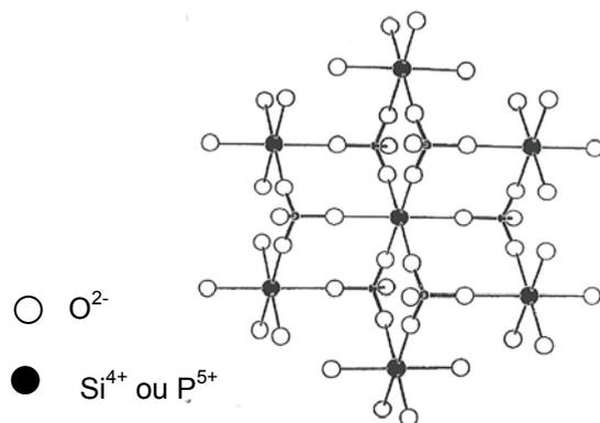
Figure IV-13 : Structure de la Larnite  $\text{Ca}_2\text{SiO}_4$
