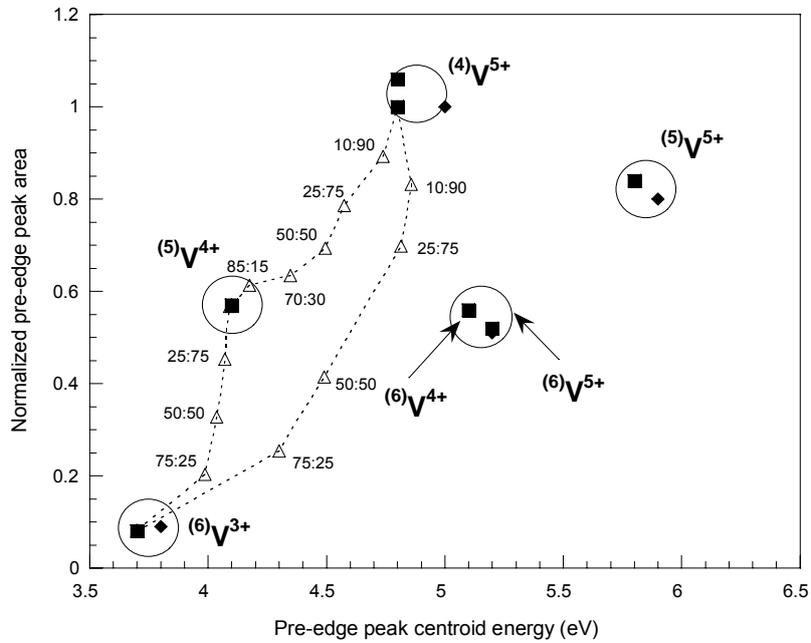
Figure II-21 : Relation entre l'aire du prépic et son centroïde pour les composés de référence ( ${}^{(n)}V^{i+}$ , avec  $i$  degré d'oxydation et  $n$  indiquant la symétrie)
