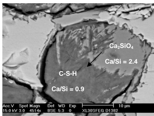
Figure IV-25 : Image MEB-BSE montrant l'hydratation de la Larnite dans la zone altérée d'un grain de laitier LAC vieilli en lysimètre
