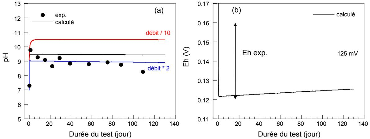
Figure VI-9 : Evolution du pH et du Eh (mesurés expérimentalement (exp.) et calculés par CHESS (calculé)) dans le réacteur du montage CTG-Leachcrete en fonction du temps.
