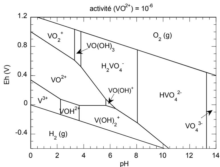
Figure V-19 : Diagramme Eh/pH des espèces aqueuses du V calculé avec le code CHESS (147) pour une activité en V de  $10^{-6}$
