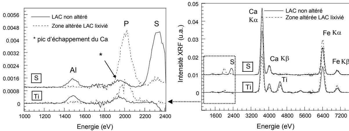
Figure IV-33 : Spectres extraits par l'analyse SIMPLISMA à partir des variables pures Ti et S, caractéristiques de la Brownmillerite (LAC non altéré et zone altérée d'un grain lixivié 130 jours en CTG-Leachcrete)
