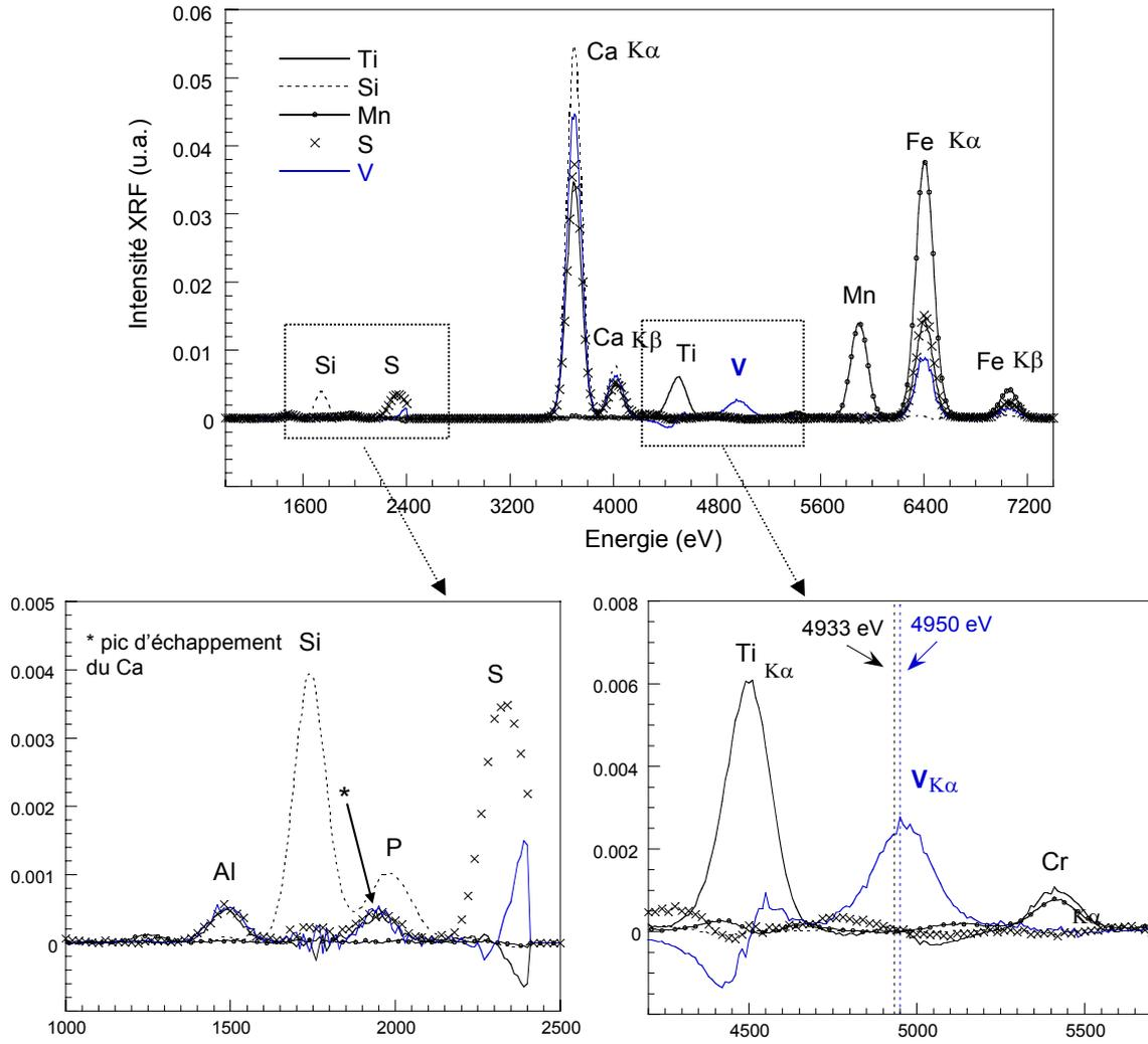
Figure V-30 : Spectres  $\mu$ -XRF extraits par l'analyse SIMPLISMA à partir des « variables pures » Ti, Si, Mn, S et V (les correspondances entre les « variables pures » (VP) et les phases minéralogiques sont indiquées dans le Tableau V-15)
