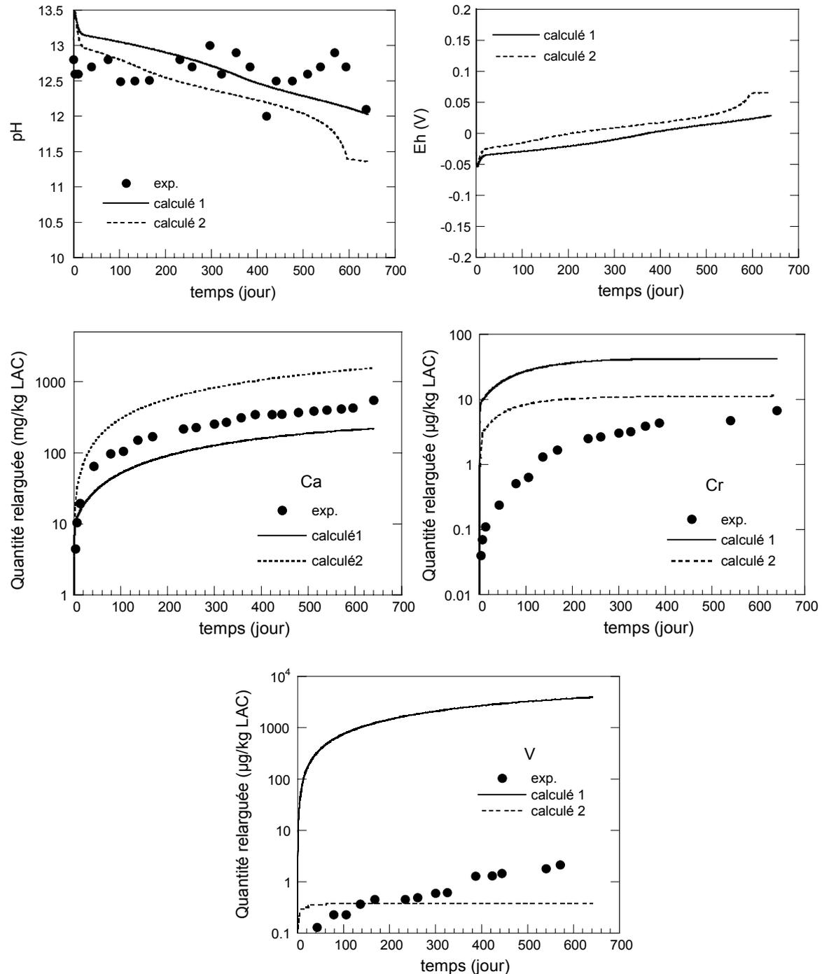
Figure VI-14 : Comparaison des résultats expérimentaux et calculés par CHESS lors de l'altération des laitiers LAC en lysimètre
