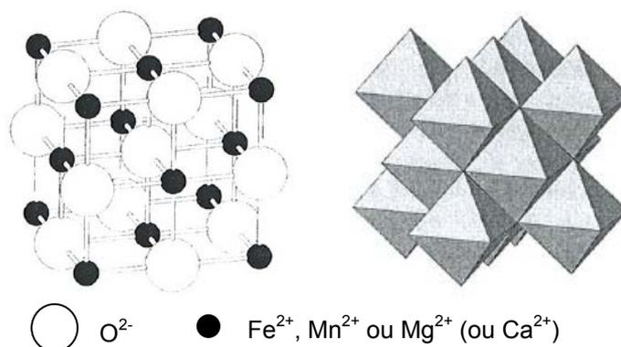
Figure IV-15 : Structure de la solution solide  $(\text{Fe}, \text{Mn}, \text{Mg}, \text{Ca})\text{O}$ , proche de la Wustite
