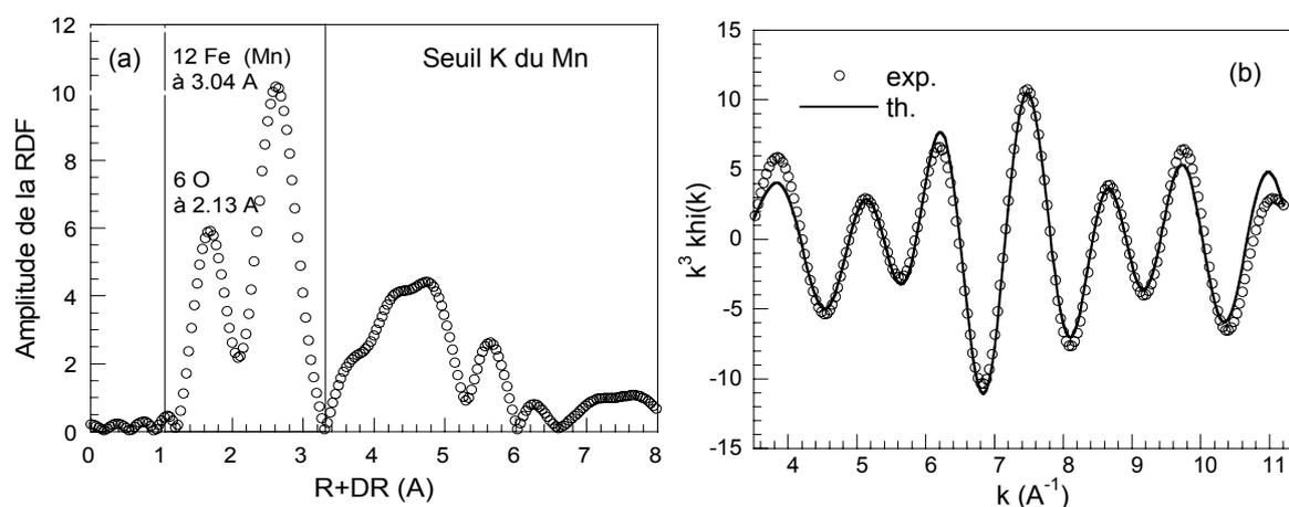
Figure IV-7 : (a) Pseudo fonction de distribution radiale (RDF) associée au spectre EXAFS de laitier LAC enregistré au seuil K du Mn et (b) ajustement du spectre partiel correspondant aux deux premiers pics de la RDF.
