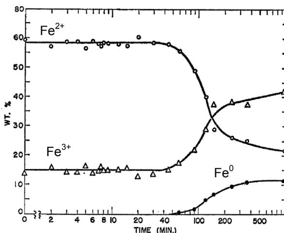
Figure 4. Chemical analyses of disproportionated samples:  $\circ$ , wt %  $\text{Fe}^{2+}$ ;  $\Delta$ , wt %  $\text{Fe}^{3+}$ ;  $\bullet$ , wt %  $\text{Fe}^0$ .
