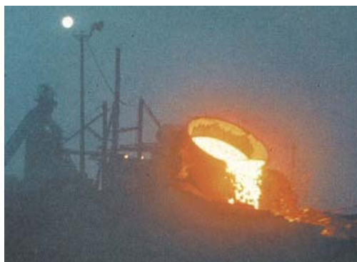
Figure I-2- Cuvier déversant le laitier en fosse (site BHP de Port Kembla, Australie)
