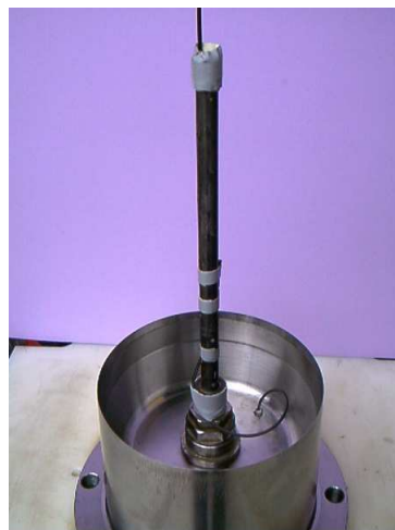
FIG. 2.13 – Système de détection d'allumage par fibre optique
