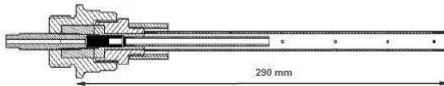
FIG. 2.11 – Schéma d'un allumeur
