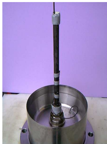
FIG. 2.13 – Système de détection d'allumage par fibre optique
