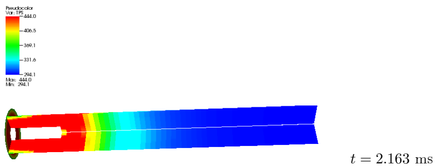
FIG. 5.17 – Évolution du front de flamme dans le lit de poudre en 3 dimensions d'espace. Tracé de la température de surface des grains au cours du temps.
