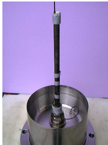
FIG. 2.13 – Système de détection d'allumage par fibre optique
