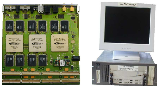
FIG. 4.18 – Illustration de la carte fille composée de deux FPGA STRATIX EP1S80F-C6 et d'un FPGA EP1S25F-C6. Une partie de ce dernier est utilisé pour la communication avec le bus PCI. La plate-forme de test dans un châssis de PC est aussi illustrée.
