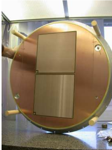
FIG. A.3 – Photographie de deux prototypes bulk MICROMEGAS ( 26 \times 27 \text{ cm}^2 ) pour les tests de validation du projet T2K réalisés sur la TPC de HARP (au CERN).
