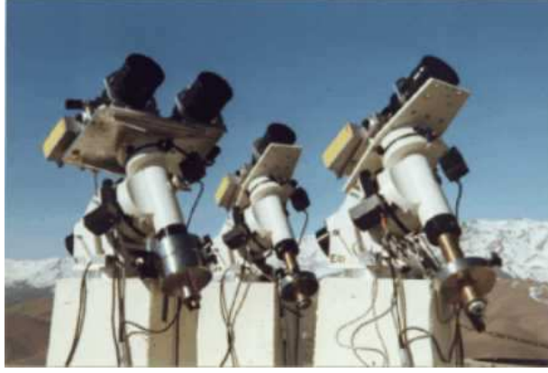
FIG. 1.9 – Photo du Generalized Seeing Monitor (GSM) et représentation de sa configuration standard à 4 télescopes (F. Martin et al 1998 [94], A. Ziad et al 2000 [171]). Il permet d’effectuer une analyse statistique des fluctuations d’AA pour déterminer les paramètres optiques de la turbulence atmosphérique.
