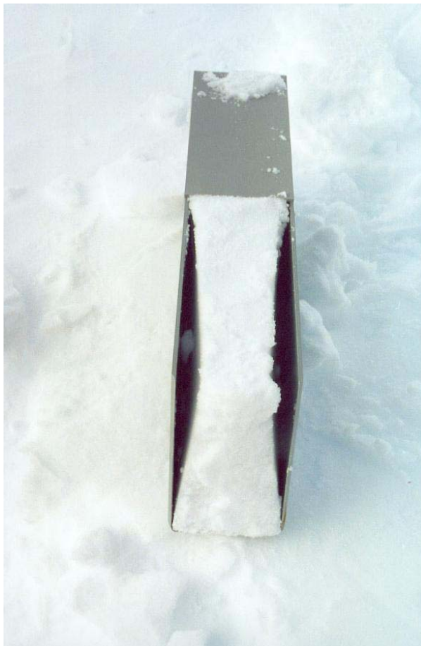
Figure 4.8 : déformation de la première boîte expérimentale (en plastique sans étais) après que celle-ci ait été enfoncée dans le manteau neigeux (voir les dimensions de la boîte sur la Figure 4.3 ).
