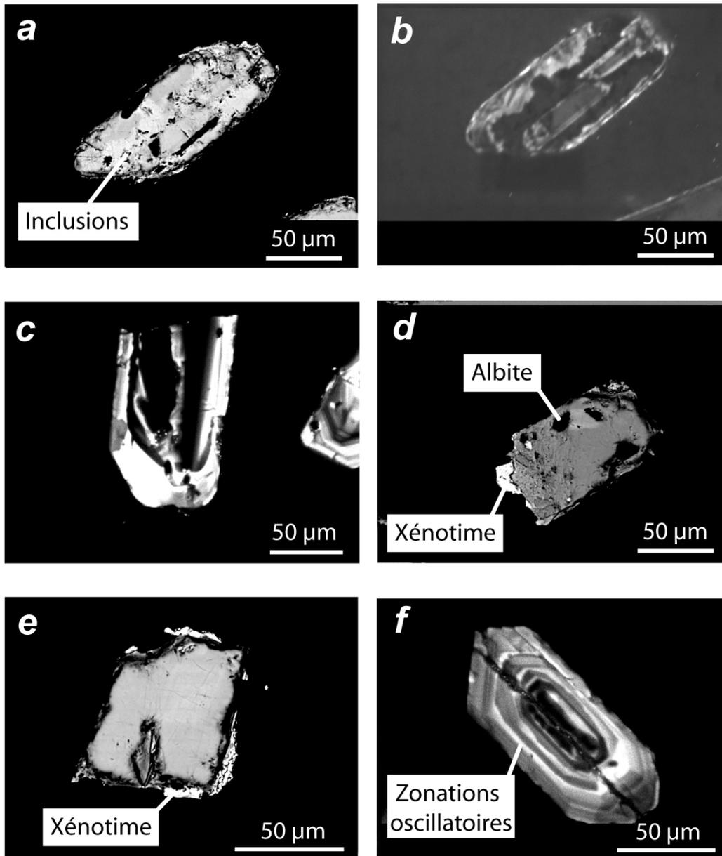
**Figure III-39** : Images MEB (a, d, e : en électrons retrodiffusés; b, c, f : en cathodoluminescence) des zircons de l'albitite (JM04-12). a, b et c : zircon présentant une texture de dissolution-reprécipitation (zone noire en cathodoluminescence). d : zircon hydrothermal renfermant une inclusion d'albite et une surcroissance de xénotime. e : zircon avec une surcroissance de xénotime. f : zircon caractérisé par des zonations oscillatoires
