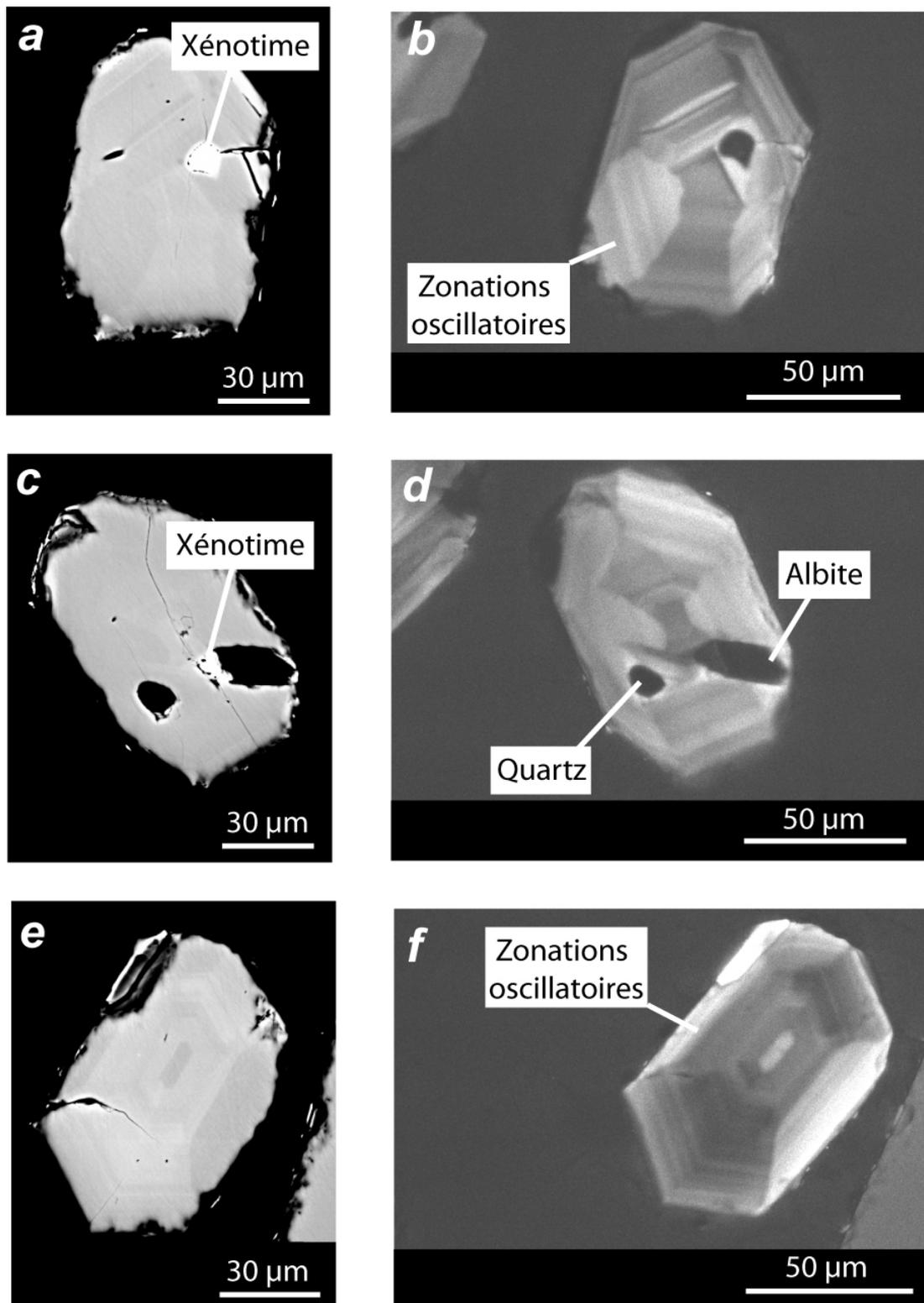
**Figure III-38** : Images MEB (a, c, e : en électrons retrodiffusés; b, d, f : en cathodoluminescence) des zircons de la métatuffite rhyolitique rubanée et albitisée (JM04-14). a, b, c, d : zircons hydrothermaux renfermant des inclusions de xénotime, quartz et albite et présentant des zonations oscillatoires. e, f : zircon magmatique caractérisé par des zonations oscillatoires.
