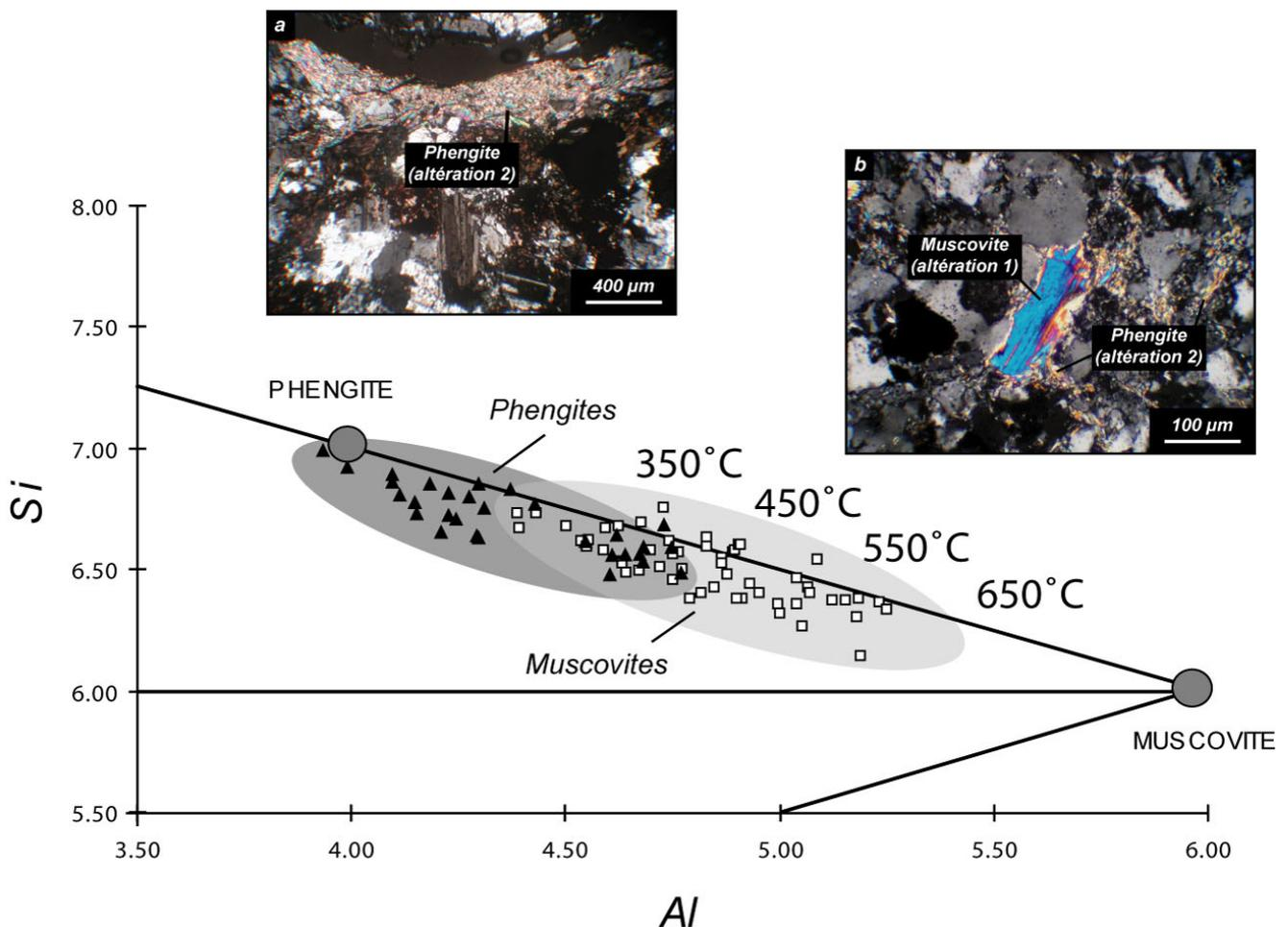
**Figure III-10** : Caractérisation des muscovites dans le diagramme Si/Al de Velde (1965). Les températures indiquées sur la ligne muscovite-phengite sont calculées à partir du géothermomètre de Monier et Robert (1986). Photographie de lames minces : (a) phengites associées à l'altération 2, (b) muscovite associée à l'altération 1 et entourée de phengites liées à l'altération 2.
