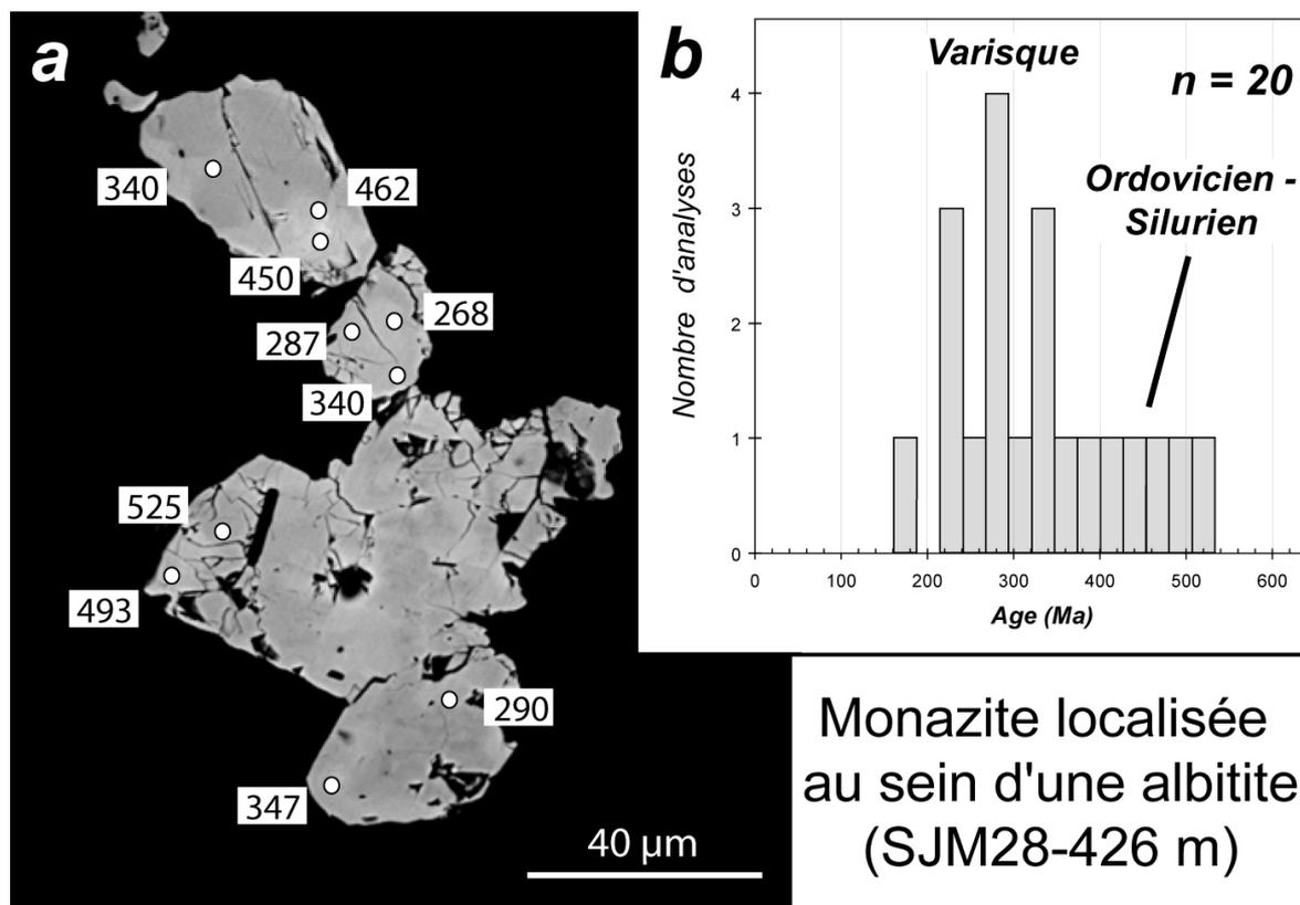
**Figure III-36** : a. Images MEB (en électrons rétrodiffusés) d'un grain de monazite dont les âges obtenus varient entre 268 et 525 Ma. b. Histogramme des âges U-Th-Pb compris entre 162 Ma et 525 Ma; la majorité des résultats sont compris entre 220 et 320 Ma.
