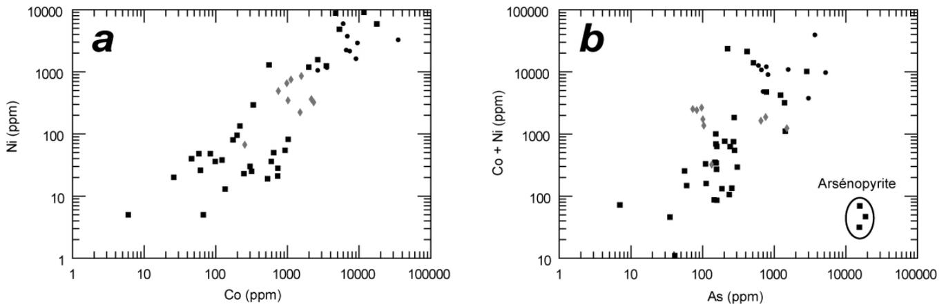
**Figure III-25 :** a. diagramme Log(Ni) en fonction de Log(Co) montrant une corrélation positive entre ces deux éléments. b. diagramme Log(Co+Ni) en fonction de Log(As) présentant une corrélation positive exceptée pour trois analyses qui indiquent la présence d'arsenopyrite. Les carrés représentent les pyrites des veines de quartz, les losanges représentent les pyrites des brèches à hématite et les ronds représentent les pyrites disséminées.
