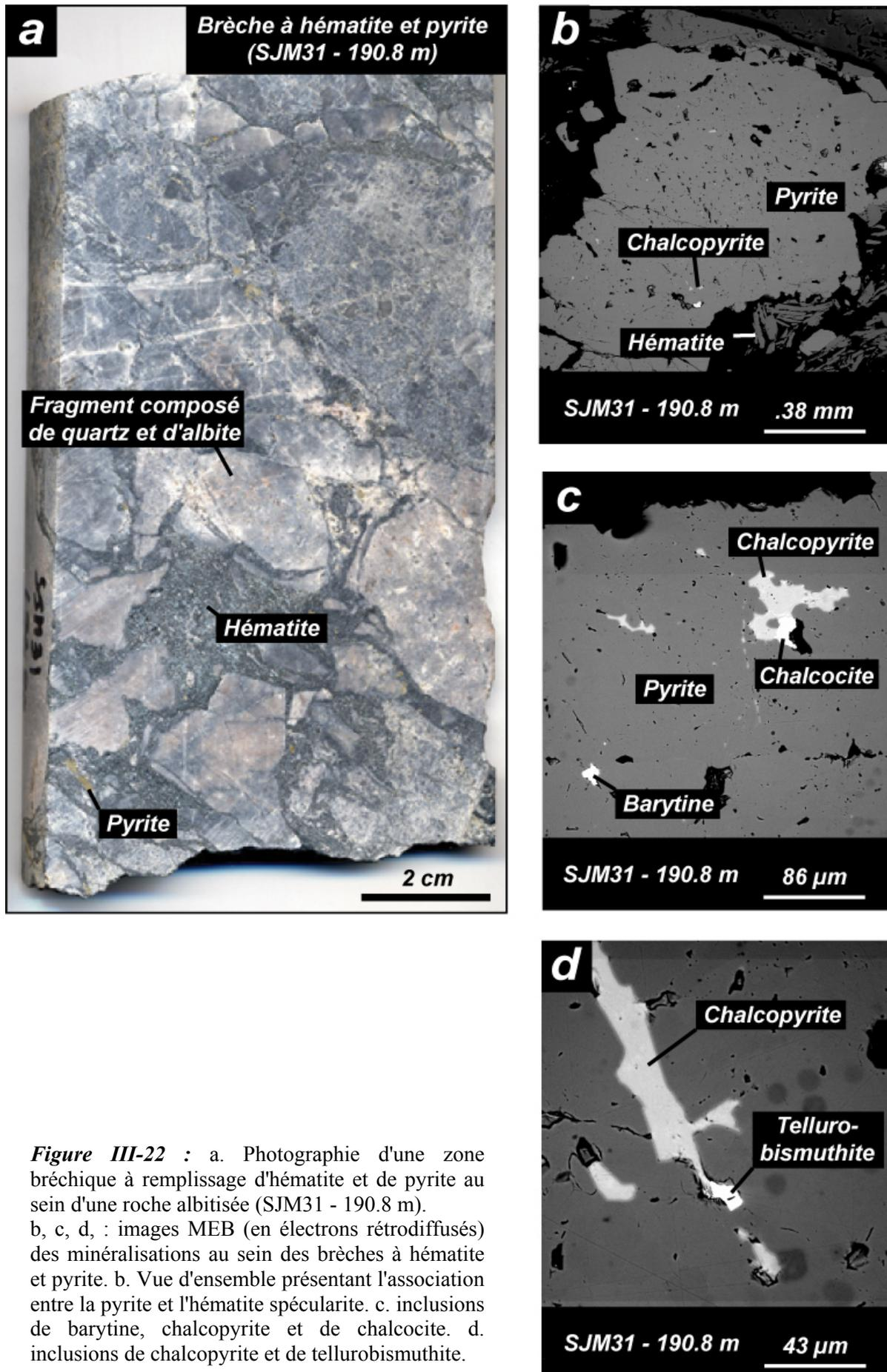
**Figure III-22 :** a. Photographie d'une zone bréchique à remplissage d'hématite et de pyrite au sein d'une roche albitisée (SJM31 - 190.8 m). b, c, d : images MEB (en électrons rétrodiffusés) des minéralisations au sein des brèches à hématite et pyrite. b. Vue d'ensemble présentant l'association entre la pyrite et l'hématite spéculaire. c. inclusions de barytine, chalcopryrite et de chalcocite. d. inclusions de chalcopryrite et de tellurobismuthite.
