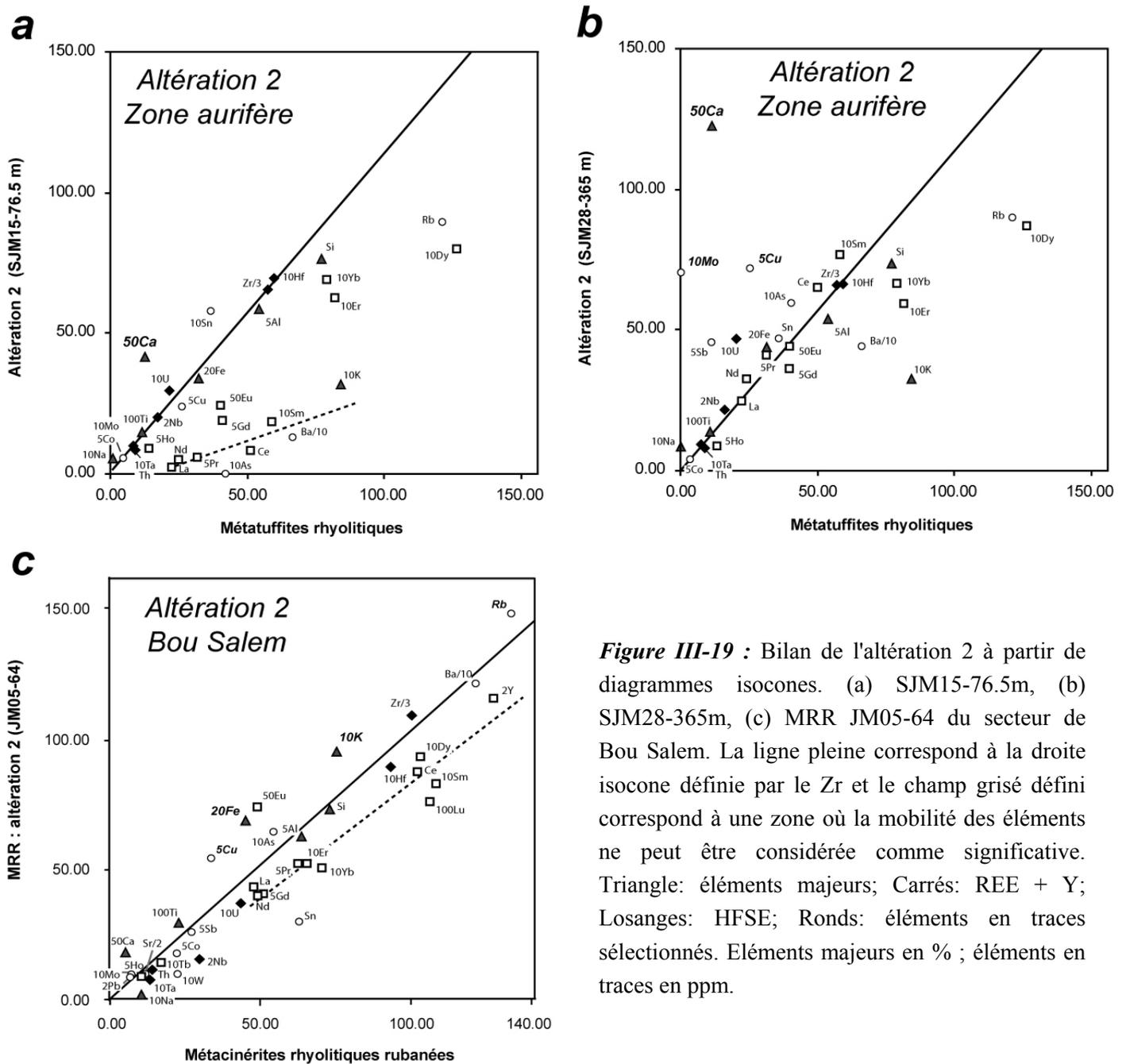
**Figure III-19** : Bilan de l'altération 2 à partir de diagrammes isocones. (a) SJM15-76.5m, (b) SJM28-365m, (c) MRR JM05-64 du secteur de Bou Salem. La ligne pleine correspond à la droite isocone définie par le Zr et le champ grisé défini correspond à une zone où la mobilité des éléments ne peut être considérée comme significative. Triangle: éléments majeurs; Carrés: REE + Y; Losanges: HFSE; Ronds: éléments en traces sélectionnés. Eléments majeurs en % ; éléments en traces en ppm.
