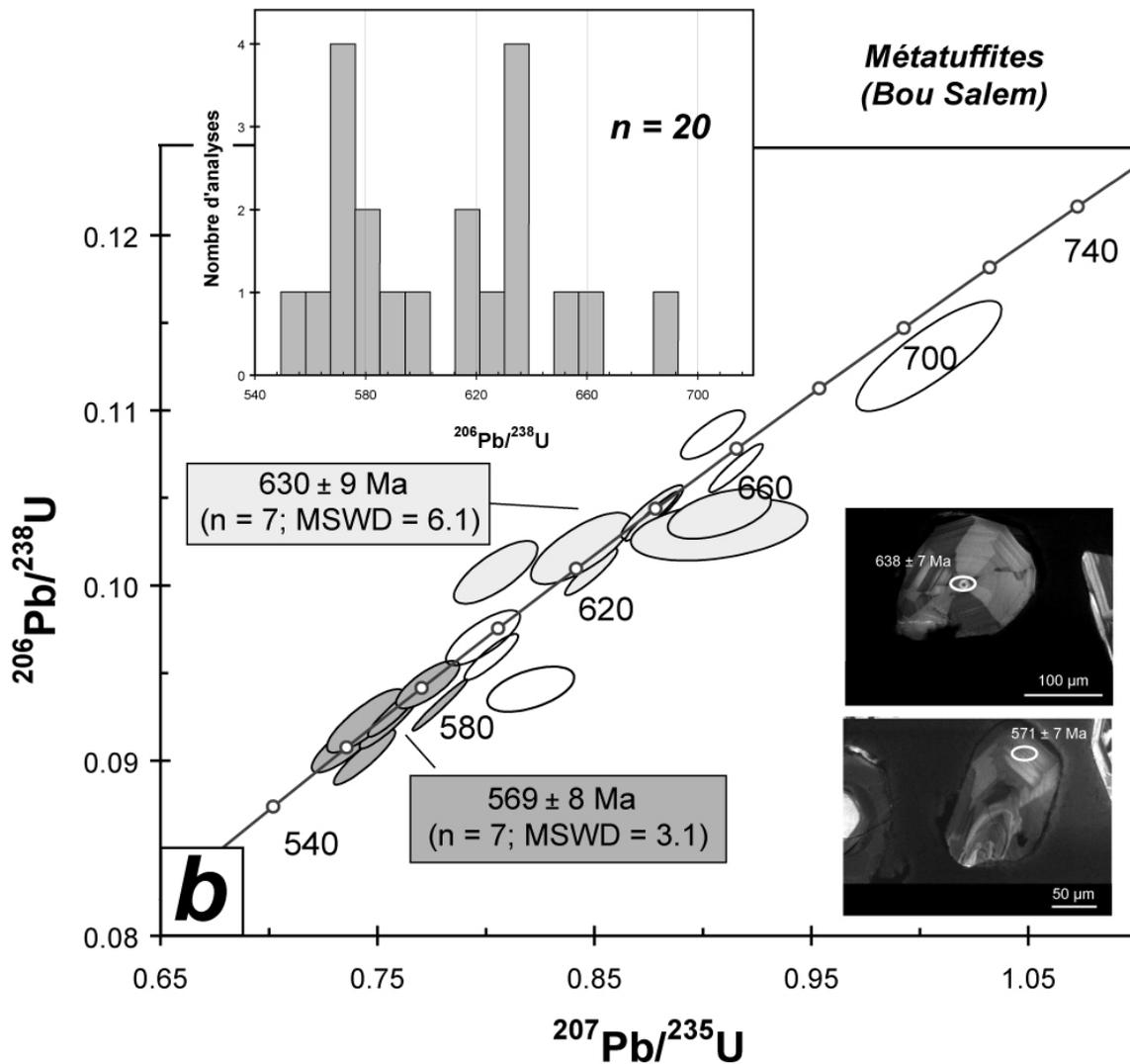
**Figure II-25 B :** Diagramme concordia ( $^{206}\text{Pb}/^{238}\text{U}$  vs  $^{207}\text{Pb}/^{235}\text{U}$ ) des analyses sur monograin de zircon de la métatuffite de Bou Salem (JM05-15). En médaillon : Histogramme des âges  $^{206}\text{Pb}/^{238}\text{U}$  pour les zircons dont les analyses ont donné des âges compris entre 550 et 700 Ma
