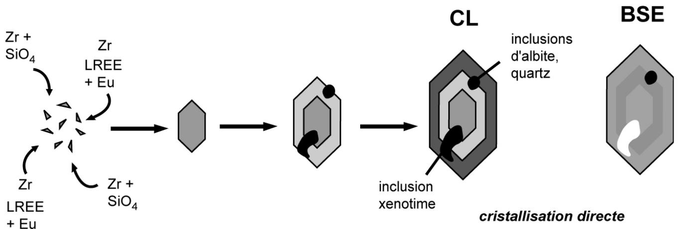
Figure III-45 : Modèles d'altération des zircons magmatiques et de formation des zircons hydrothermaux. Pour les zircons hydrothermaux, le Zr provient du protolithe. CL : image en cathodoluminescence; BSE : image en électrons rétrodiffusés.
