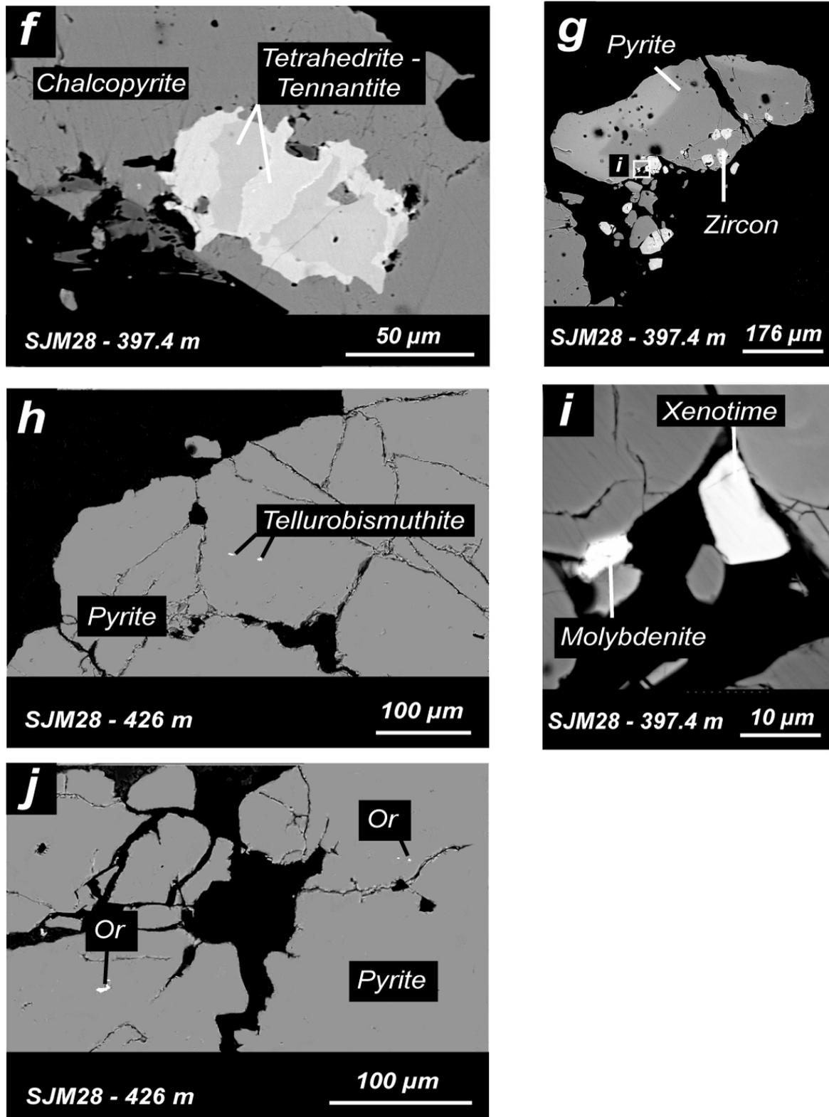
**Figure III-23 -suite-** : f. inclusion de tennantite - tétrahédrite au sein d'une chalcoppyrite, les différences de teinte de gris sont liées aux variations de As et Sb. g. Pyrite zonée renfermant des inclusions de zircon; l'emplacement de la figure i est représenté sur l'image. h. inclusions de tellurobismuthite dans une pyrite homogène. i. présence de molybdénite et de xénotime en association avec la pyrite. j. inclusions d'or au sein d'une pyrite homogène.
