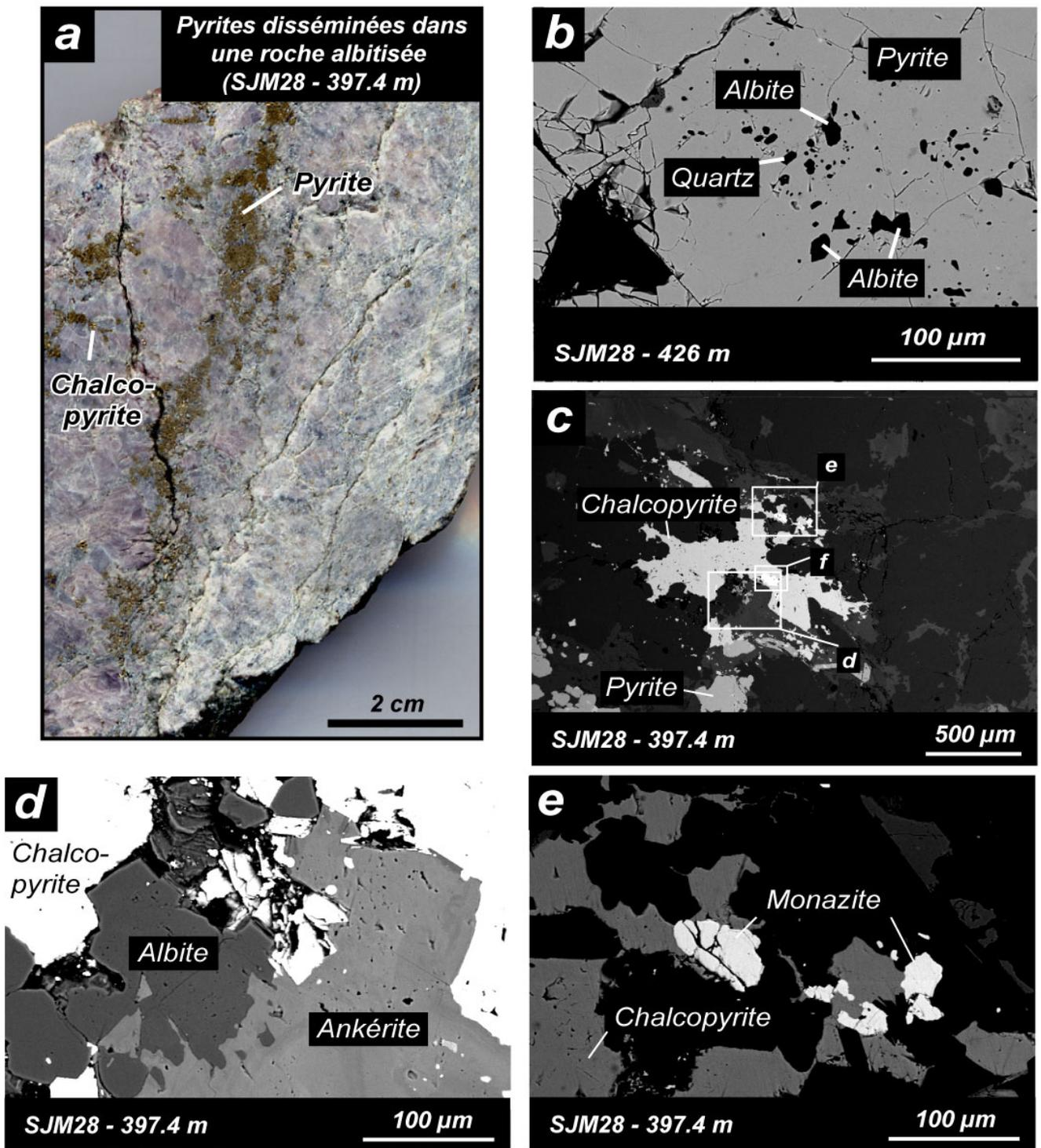
**Figure III-23 :** a. Photographie de sulfures disséminés (pyrite et chalcoppyrite) au sein d'une roche fortement albitisée (SJM28 - 397.4 m). b, c, d, e, f, g, h, i: images MEB (en électrons rétrodiffusés) des minéralisations disséminées. b. inclusions d'albite et de quartz dans une pyrite. c. et d. chalcoppyrite disséminée dans une matrice composée d'albite et d'ankérite. e. association chalcoppyrite et monazite.
