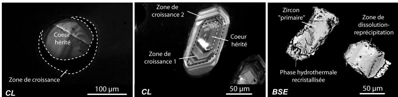
**Figure A5-3** : Exemples de textures internes et de zones de croissances observées au MEB en électrons rétrodiffusés (BSE) et en cathodoluminescence (CL). Zircons provenant des formations volcano-sédimentaires de la boutonnière de Tamlalt.
