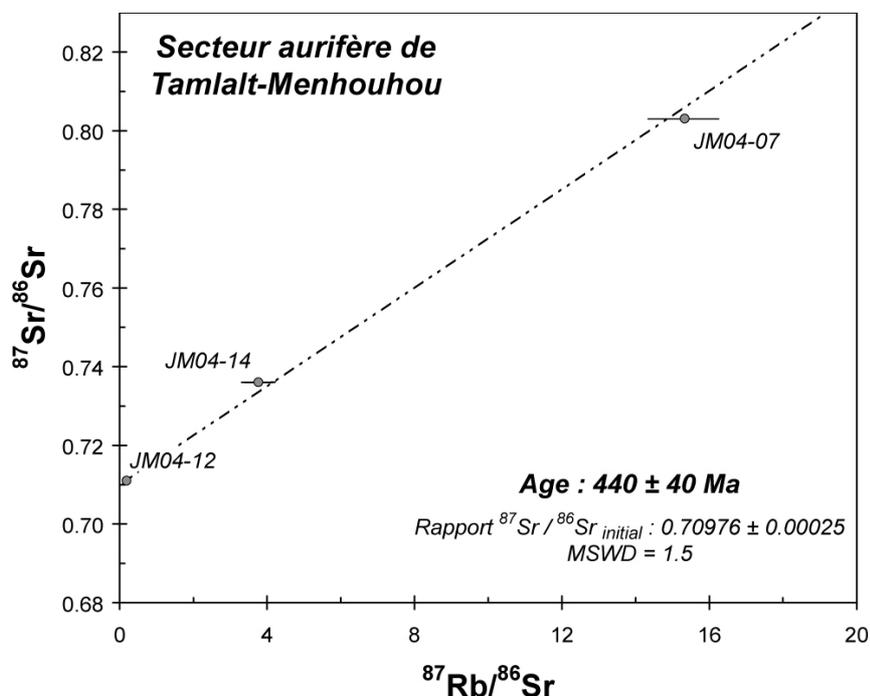
**Figure III-32** : Digramme isochrone Rb/Sr pour les roches altérées de Tamlalt-Menhouhou. L'isochrone est calculée à partir des trois échantillons felsiques, car aucune isochrone n'a pu être obtenue à partir des 4 analyses du tableau III-8
