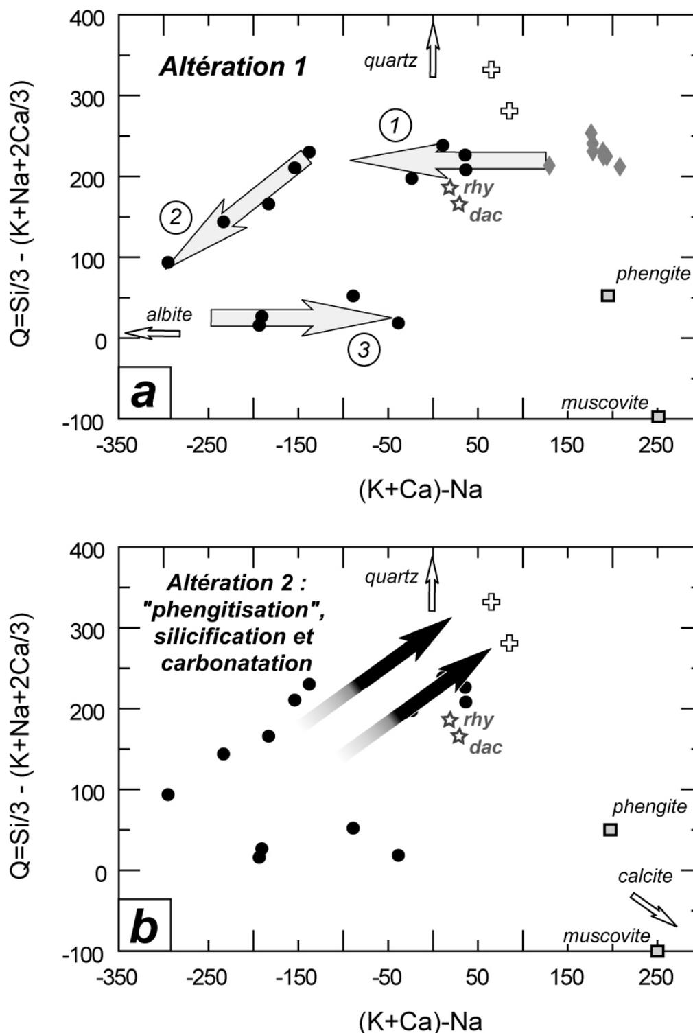
**Figure III-14** : Diagrammes chimico-minéralogiques  $(K+Ca)-Na$  en fonction de  $Q$  (d'après Charoy, 1971). **a.** mobilité des éléments lors de l'albitisation (altération 1); 1 : albitisation des feldspaths potassiques; 2 : déquartzification et néoformation d'albite; 3 : muscovitisation et carbonatation. **b.** mobilité des éléments lorsque l'altération 2 est intense.
