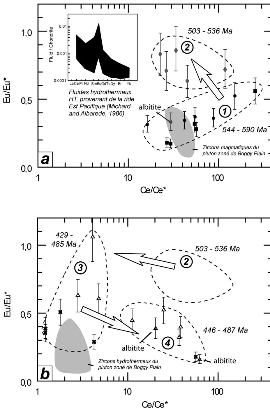
**Figure III-43 :** Diagrammes  $Eu/Eu^*$  en fonction de  $Ce/Ce^*$  (a) pour les zircons  $> 500$  Ma et (b) pour les zircons  $< 500$  Ma. Les carrés représentent les zircons magmatiques de la métatuffite de Bou Salem (JM05-15), les ronds correspondent aux zircons de la MRR albitisée (JM04-14) et les croix représentent les zircons de l'albitite (JM04-12). Les champs des zircons du pluton zoné de Boggy Plain sont également reportés.
