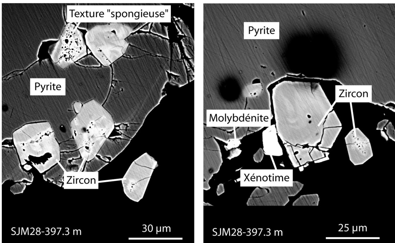
**Figure III-37 :** Images MEB (en électrons rétrodiffusés) de zircons en inclusion dans la pyrite et en association avec le xénotime et la molybdénite. Les relations pétrographiques de ces zircons avec les minéraux de l'altération 1, et leurs textures "spongieuses" indiquent qu'il s'agit de zircons hydrothermaux associés à l'hydrothermalisme sodique.
