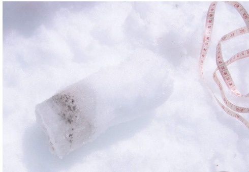
(b) Transition neige - glace dans une carotte soulignée par les poussières. Snow - ice transition featured by dust concentration in a core.
