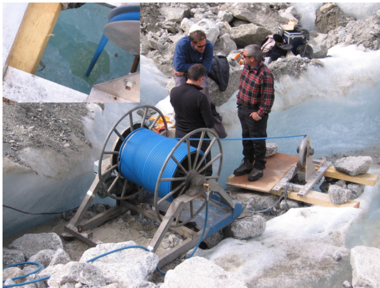
FIG. 4.4.: Mesures de l'épaisseur de glace à l'aide de forages. Thickness measurements from ice drilling down to the bedrock.
