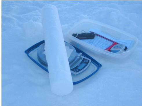
(a) Mesure de densité. Density measurement.
