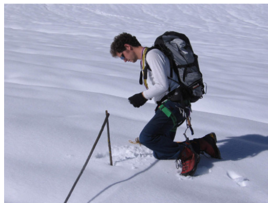
(b) Relevé d'émergence. Emergence measurement.
