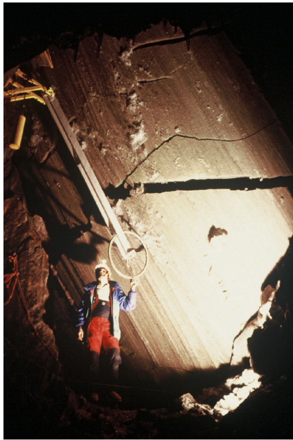
(b) Mesures de la vitesse du glissement basal dans une galerie EDF débouchant sous le glacier d'Argentière. Sliding velocity measurements from an EDF (Electricité De France) tunnel reaching the base of the glacier d'Argentière.
