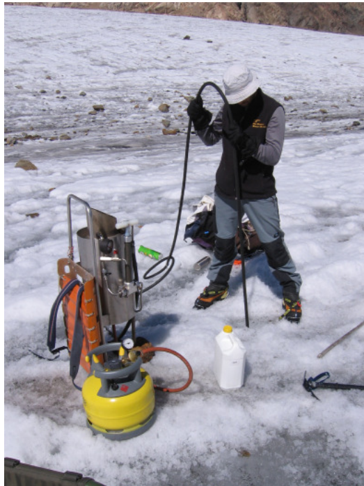
(d) Implantation d'une balise en zone d'ablation avec une sonde à vapeur en automne. Set up of a wooden stake with a steam probe in the ablation zone in autumn.
