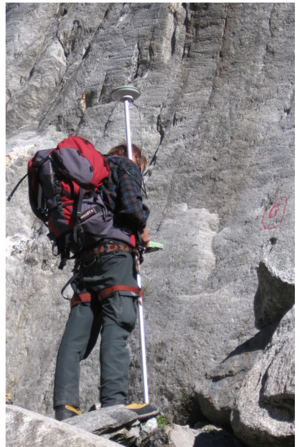
(e) Mesures topographiques à l'aide d'un GPS différentiel. Topographic measurements with a differential GPS.
