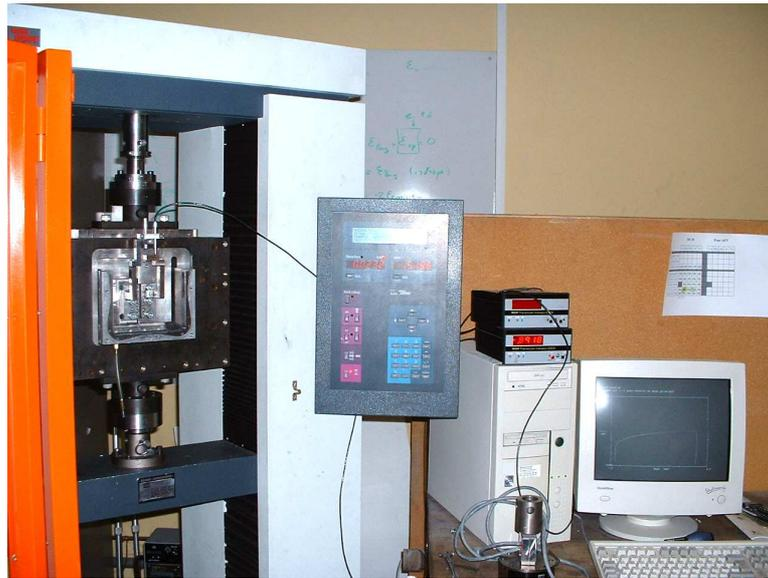
**Figure 134.** Machine de cisaillement et équipement pour effectuer le pilotage d'un essai et l'enregistrement des données (valeurs de la force et du déplacement) au cours d'un essai.
