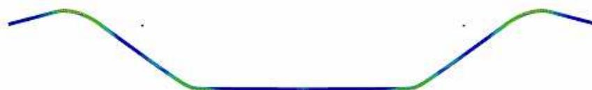
**Figure 43.** La géométrie de l'embouti après le retour élastique issue de la simulation éléments finis de la mise en forme par pliage.
