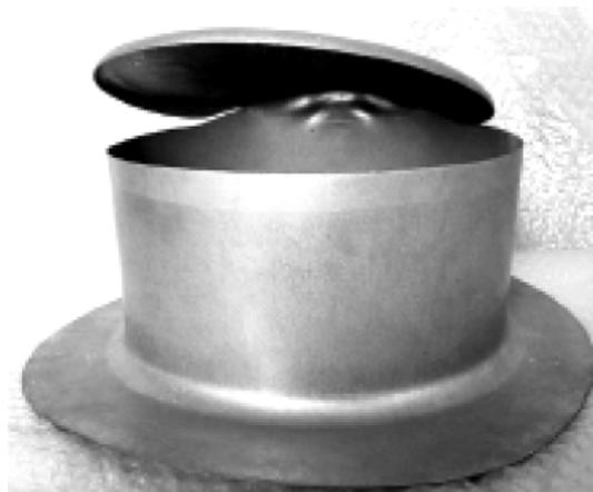
**Figure 10.** Rupture de l'embouti.
