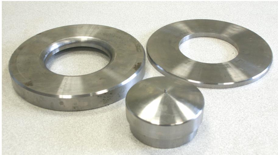
**Figure 66.** Photo de l'outillage (matrice, poinçon et serre-flan) conçu pour la validation de la simulation de l'emboutissage.
