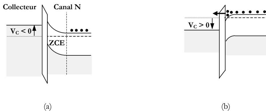
Fig.22. Structure de bandes d'énergie de la collecte des électrons du canal N pour différentes polarisations du collecteur ( V_C ). (a) à V_C < 0V , ce régime correspond à la désertion des électrons du semiconducteur, (b) à V_C > 0V , ce qui correspond à la collecte des électrons.
