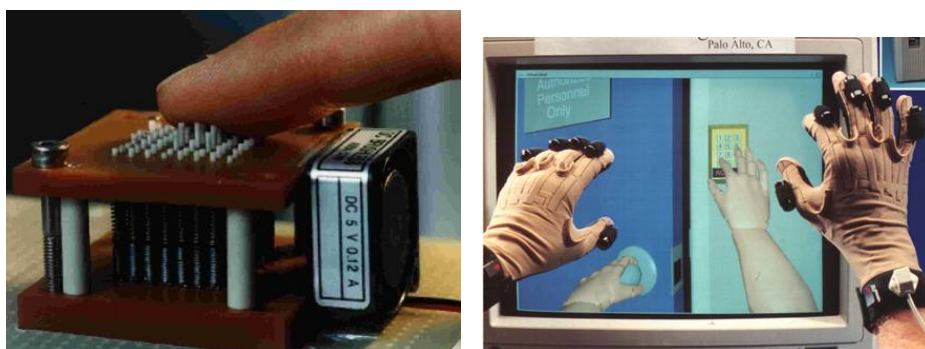
FIG. 2.5 – Dispositif tactile de type matriciel (Université de Karlsruhe) et gant vibro-tactile CyberTouch (Immersion).
