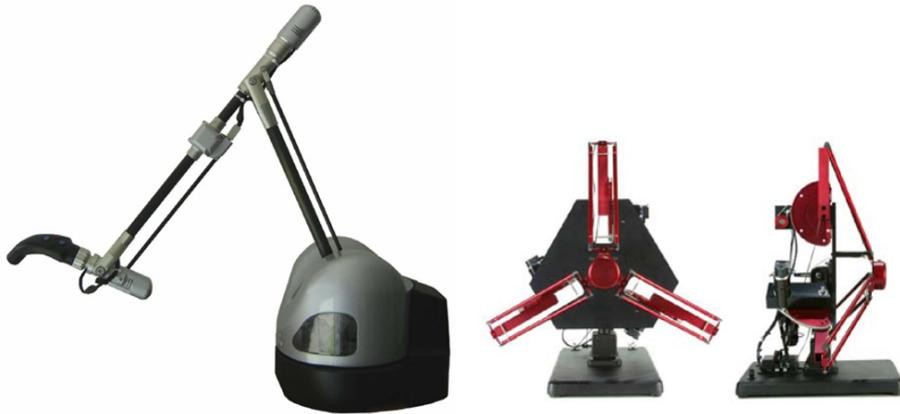
FIG. 2.6 – Dispositifs haptiques à réaction externe : bras Virtuose de Haption (structure série) et interface Delta de Force Dimension (structure parallèle).
