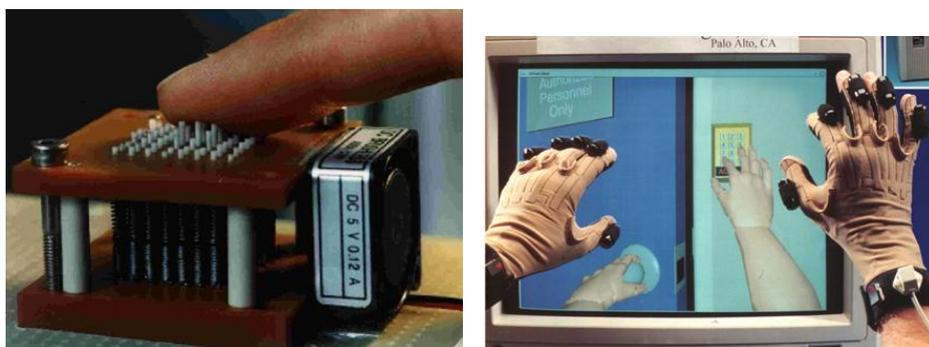
FIG. 2.5 – Dispositif tactile de type matriciel (Université de Karlsruhe) et gant vibro-tactile CyberTouch (Immersion).
