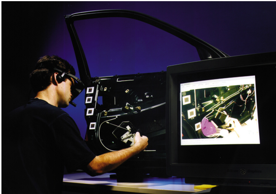
FIG. 2.14 – Multimodalité pour la Réalité Augmentée : aide au montage (Fraunhofer Institute).
