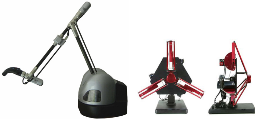
FIG. 2.6 – Dispositifs haptiques à réaction externe : bras Virtuose de Haption (structure série) et interface Delta de Force Dimension (structure parallèle).
