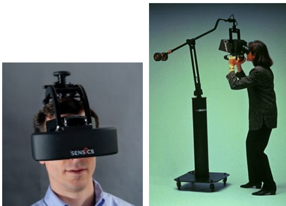
FIG. 2.3 – Visiocasque piSight de Sensics (résolution de 3200x1800 pixels par oeil, champ de vision de 150°) et visiocasque à support fixe Boom de Fakespace.
