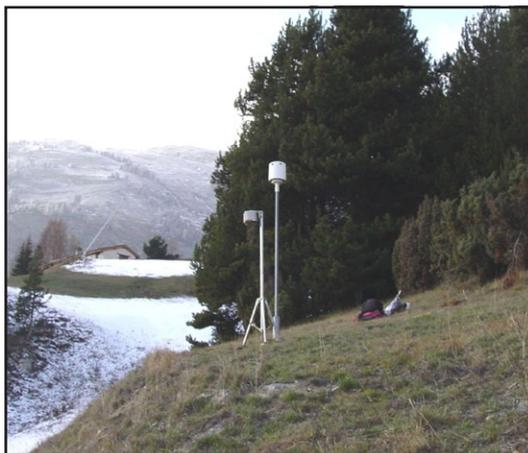
*Photo IV.1 : Sondes de température Hobo (position basse) et sonde n°7 York (position haute) en bas des pistes d'Aussois (1600m).*
