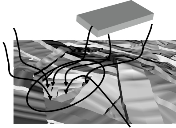
FIG. 2.34 – L'algorithme de dépôt de la fine privilégie les pores de la structure.
