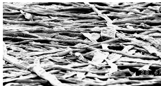
FIG. 2.26 – Image de la surface d'une formette de feuillus obtenue au MEB.
