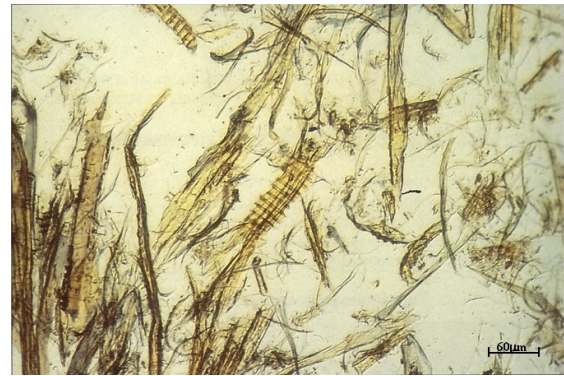
FIG. 1.8 – Image en microscopie optique d'une pâte mécanique de meule d'épicéa.
