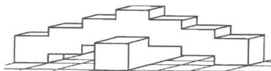
FIG. 2.11 – Conformation d'une fibre dans la simulation développée par Niskanen.
