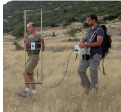
*Figure 44 : Appareils (a) RMT, (b) RF-EM et (c) VLF-gradient lors de leur utilisation sur le site de la dépression de Lousoi*
