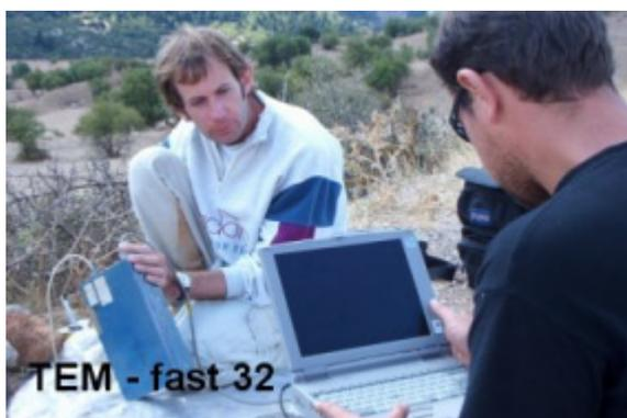
*Figure 41 : Appareil TEM-fast 32 lors de la réalisation d'un sondage sur le site de la dépression de Lousoi*
