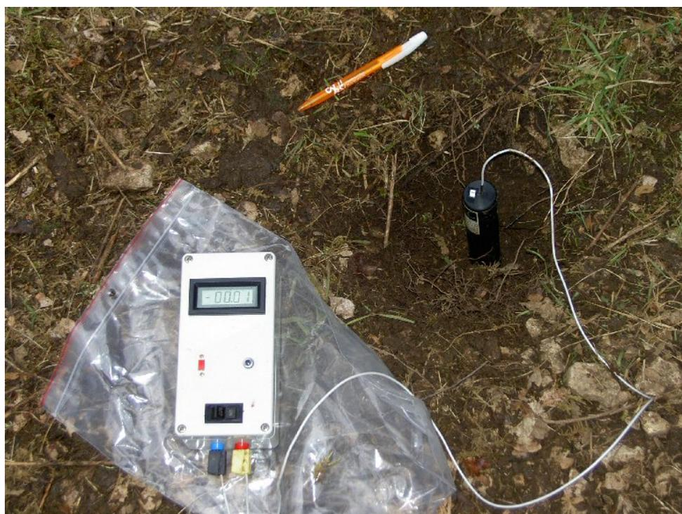
*Figure 33 : Mise en œuvre de mesures PS sur le site de Rocamadour ; le voltmètre utilisé, à haute impédance d'entrée, a été conçu à l'IRD de Bondy*
