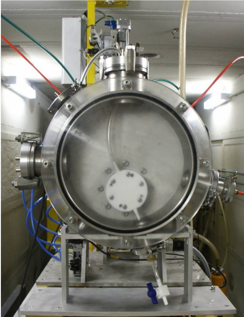
Figure III-16 : Photo de la cellule d'irradiation du CERF (cylindre blanc) installée sur la voie de faisceau extrait.
