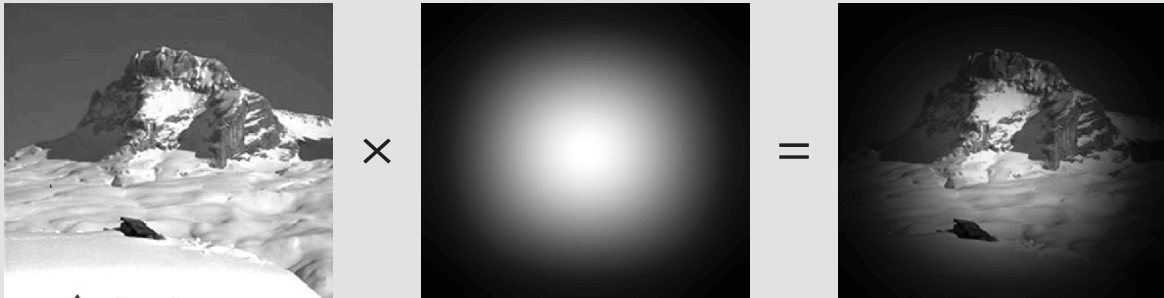
Figure I.38: fenêtrage de Hanning de l'image entrante afin de limiter les effets de bord lors du calcul de la transformée de Fourier.
