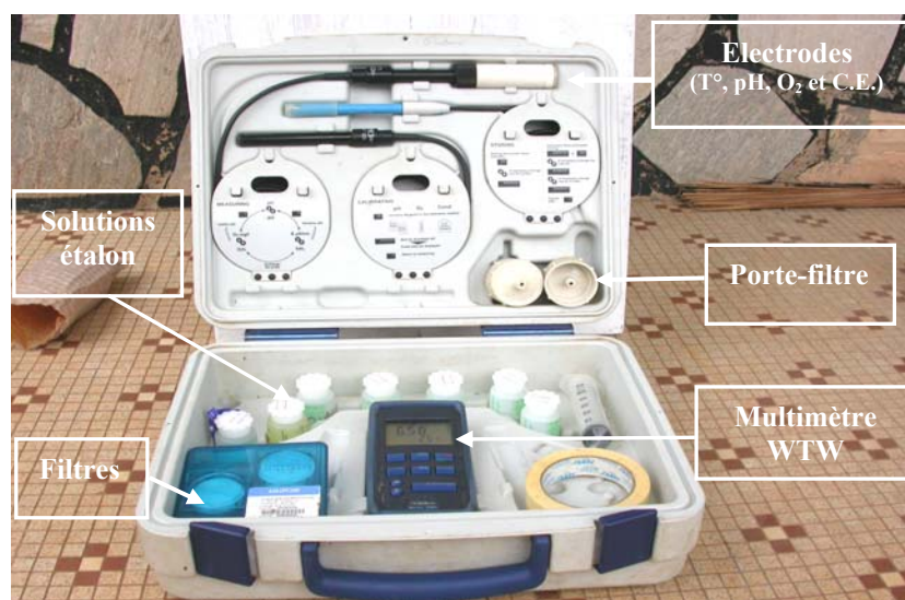
Figure 62 : Mallette de mesure physico-chimique (photo du 30/08/03).
