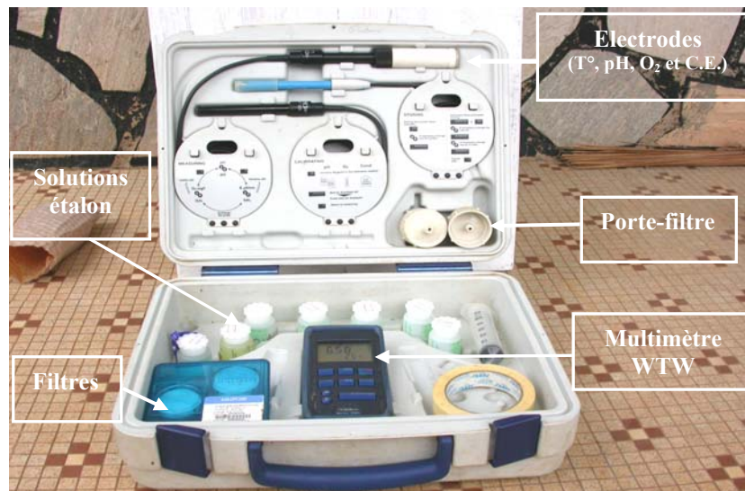
Figure 62 : Mallette de mesure physico-chimique (photo du 30/08/03).
