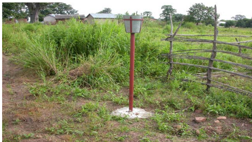
Figure 61 : Pluviomètre de Nalohou II (9°44' N, 1°36' E) servant à l'échantillonnage géochimique des précipitations (photo du 25/07/03).
