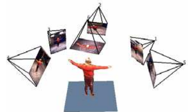
Figure 13: Position de six caméras servant à la construction du modèle 3D et au “texturage”.
