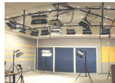
Figure 7: Balcar accrochés à la rampe et Balcar sur trépieds..
