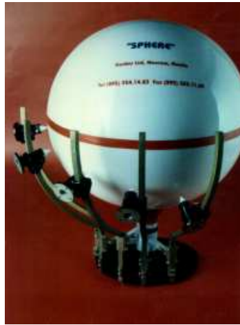
FIG. 1.45 – Photographie de l'antenne lentille de Luneburg de l'entreprise Konkur Multisat 1M.
