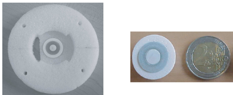
FIG. 5.14 – Photographies de la lentille HMFE à 3 coquilles avec et sans son support en mousse.
