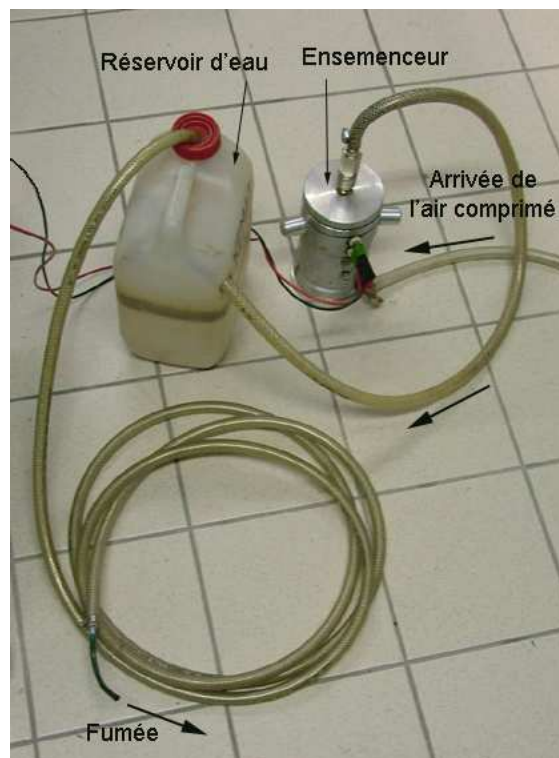
Fig. 2.2: Photo du dispositif d'ensemencement à la fumée de bois.
