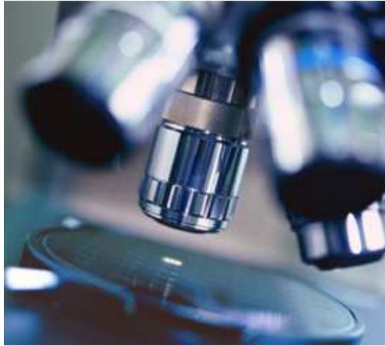
FIG. 2.6 – Microscope photonique à faible distance de travail.
