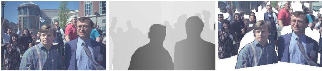
FIG. 2.27 – De gauche à droite : image originale ; définition des calques en fonction de leur profondeur ; représentation de la scène sous forme de calques texturés. (Images S. Baker, R. Szeliski et P. Anandan ©1998 IEEE)
