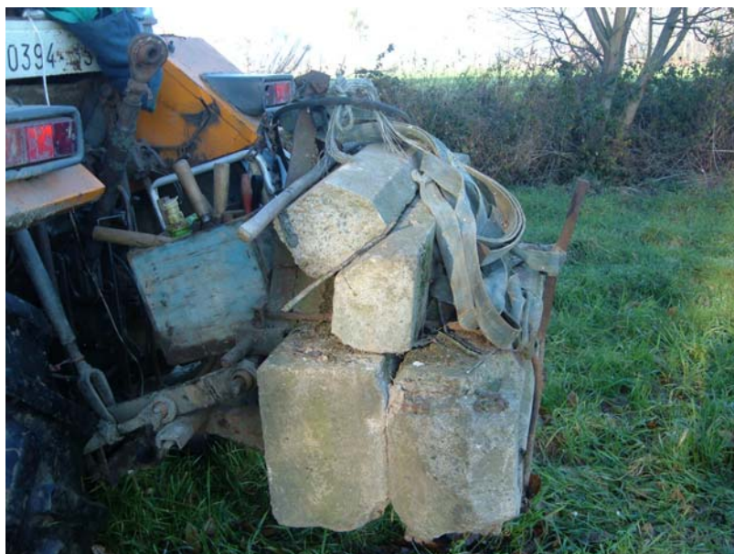
Fig. 28 : contrepoids à l'arrière du tracteur
