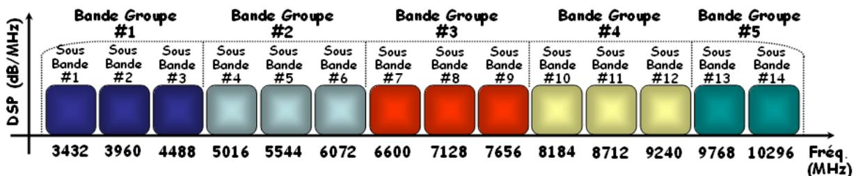
Figure II.8 : Découpage fréquentiel de la bande ULB comprise entre 3,1 et 10,6 GHz en 14 SB regroupées en 5 groupes de bandes.
