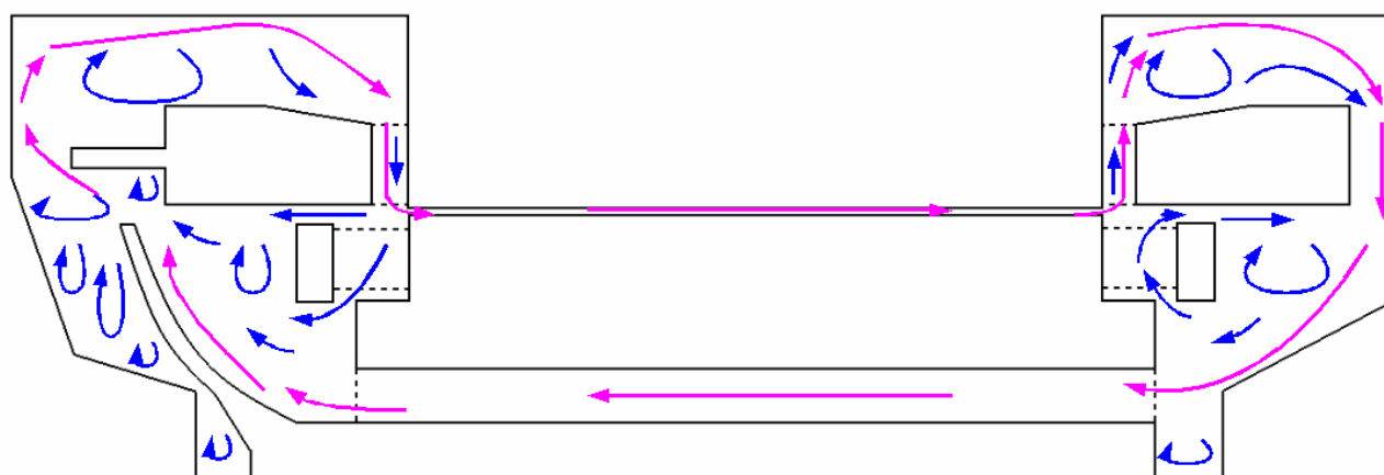
Figure 6 Structure globale de l'écoulement dans le moteur d'étude
