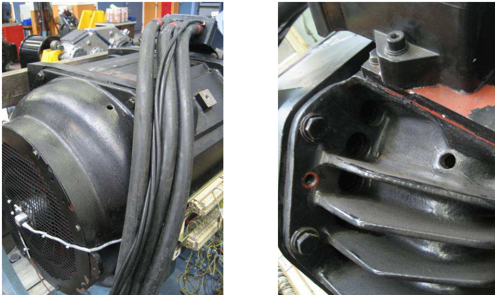
Figure 15 Orifices percés dans les flasques
