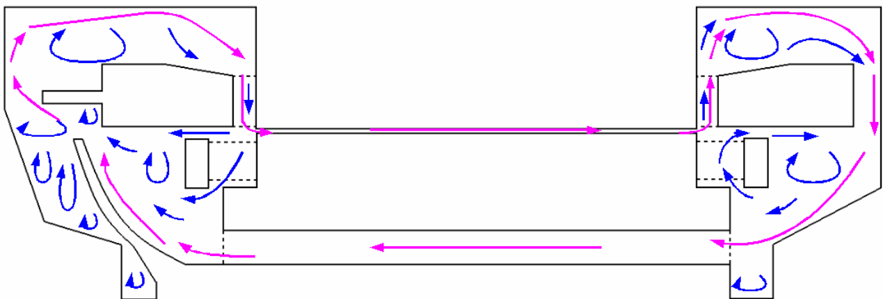
Figure 6 Structure globale de l'écoulement dans le moteur d'étude
