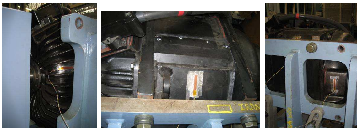
Figure 13 Emplacement des capteurs de flux sur les parois extérieures du moteur d'essais
