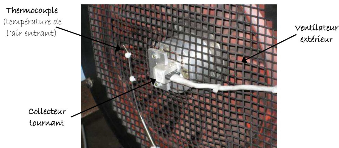
Figure 4 Collecteur tournant en bout d'arbre
