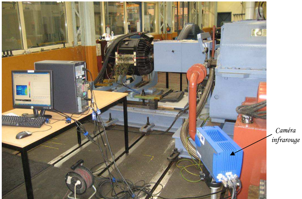
Figure 14 Emplacement de la caméra infrarouge
