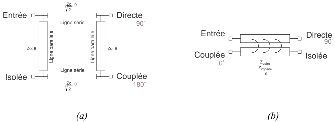
Figure III.10 : (a) Schéma équivalent d'un coupleur BranchLine (b) Schéma équivalent d'un coupleur BroadSide
