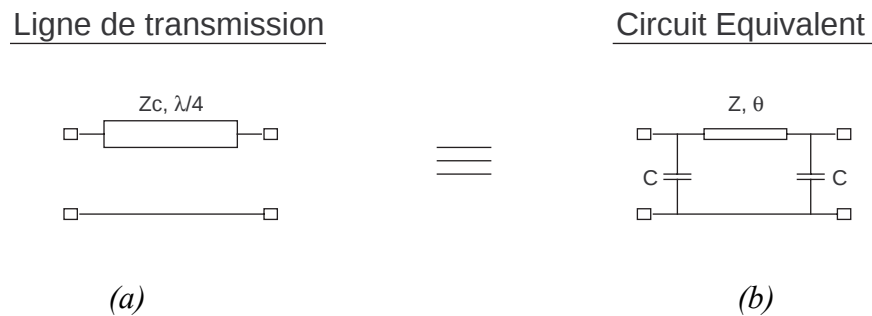
Figure III.24 : (a) Schéma d'une ligne de transmission quart d'onde (b) Schéma électrique équivalent de la ligne quart d'onde
