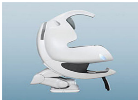
Figure 10 I-foot : robot transporteur de Toyota pour des personnes avec mobilité réduite.
