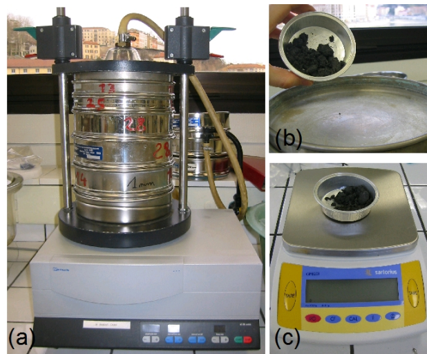
FIG. 3.10 – Granulométrie des sédiments fins par tamisage : (a) colonne de tamis, agitateur mécanique et circuit d'eau, (b) échantillon de sédiments fins prélevé dans un dépôt du lit, (c) pesée (résolution 0.01 g). Photos©M. Lagouy.
