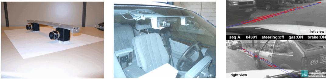
FIG. 1.7 – Système de vision binoculaire pour le repérage par caméra. Exemple de reconnaissance de la chaussée.
