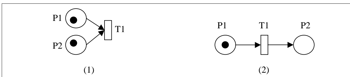
Figure 69. Synchronisation et précedence dans un RdP
