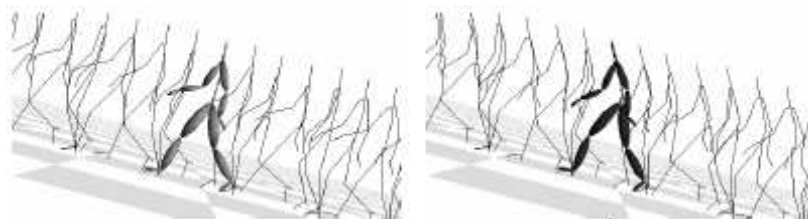
Figure 2.31: Marche en plan incliné : a) Mouvement initial, sans contrainte physique; b) Prise en compte du ZMP (Shin et coll., 2003).
