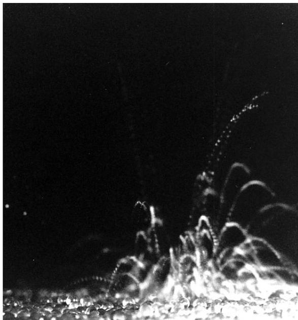
FIG. 3.1 – Collision d'une bille de verre sur un empilement tridimensionnel de billes de même nature
