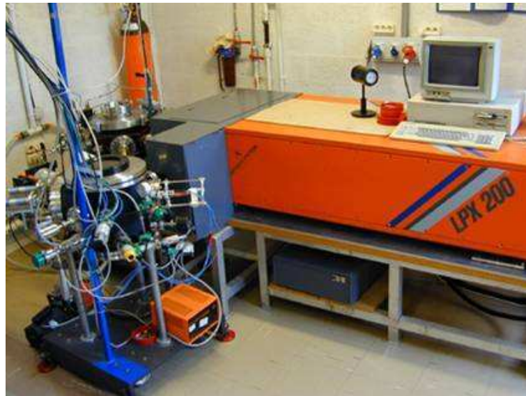
FIG. II.1 – Système de dépôt de films minces par ablation laser pulsé de Caen (laser KrF \lambda = 248\text{nm} ).
