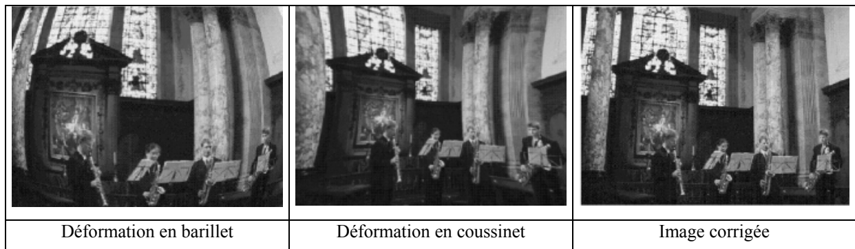
Figure 11: Distorsions radiales causées par les lentilles [TOR 04]
