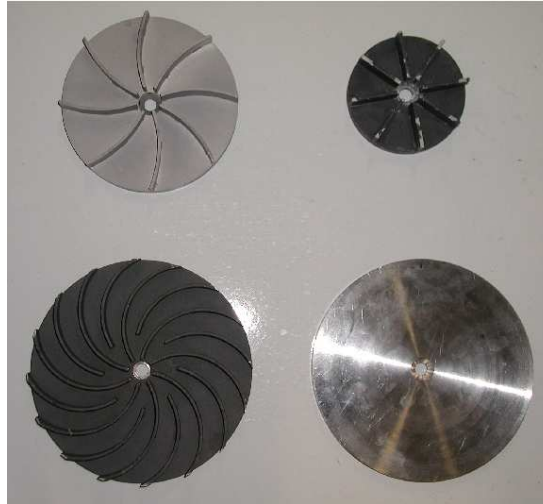
FIG. 2.3: Les quatre types de turbines utilisées durant cette thèse. De haut en bas et de gauche à droite : TM73, TM90, TM60, Lisse.
