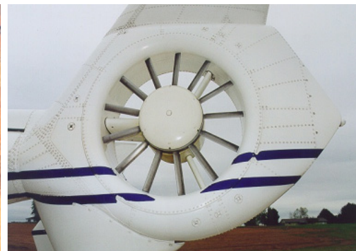
FIG. 1.14. Fenestron d'un hélicoptère Dauphin
