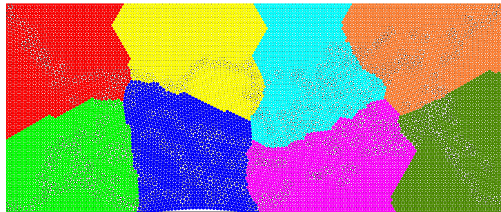
(a) Décomposition en 8 domaines en utilisant l'heuristique de Fiduccia-Mattheyses pour le raffinement. La coupe est égale à 714 arêtes.
