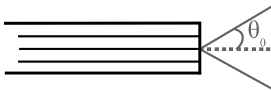
FIG. 3.3 – Angle critique d'une fibre.
