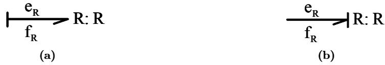
FIG. 2.2 – (a) : Élément  $R$  déterministe en causalité résistance. (b) : Élément  $R$  déterministe en causalité conductance
