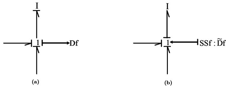
FIG. 3.1 – (a): BG en causalité intégrale avec un détecteur de flux. (b): BG en causalité dérivée avec un détecteur de flux dualisé.
