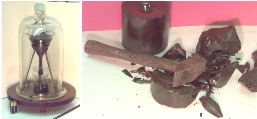
FIG. 1.7: A gauche, dispositif expérimental de la "Pitch Drop Experiment" de Thomas Parnell. On voit clairement le matériau couler. A droite, le matériau dont est rempli l'entonnoir de gauche, avant et après impact. Il est donc cassant.
