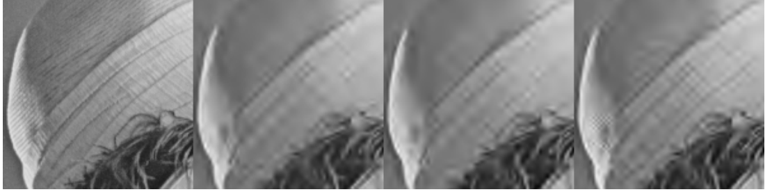
FIG. 2.4 – Zoom sur le chapeau de Lena pour un taux de compression de 64 : 1 (0,125 bit/pixel), images de gauche à droite : originale, SPIHT, JPEG2000, QVAZM.
