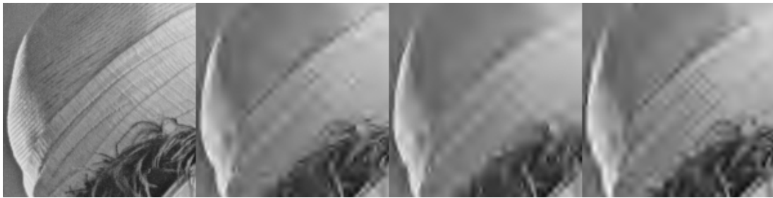
FIG. 2.3 – Zoom sur le chapeau de Lena pour un taux de compression de 103 : 1 (0,0777 bit/pixel), images de gauche à droite : originale, SPIHT, JPEG2000, QVAZM.
