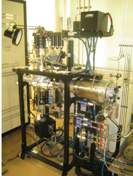
Figure II- 8 Nouveau réacteur de croissance MPCVD de type Seki du NIMS consacré à la croissance de diamant dopé au bore
