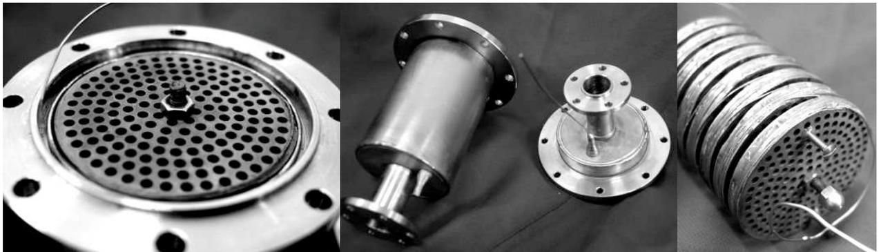
FIG. 5.11: Photos de l'échangeur vapeur type "calibré"
