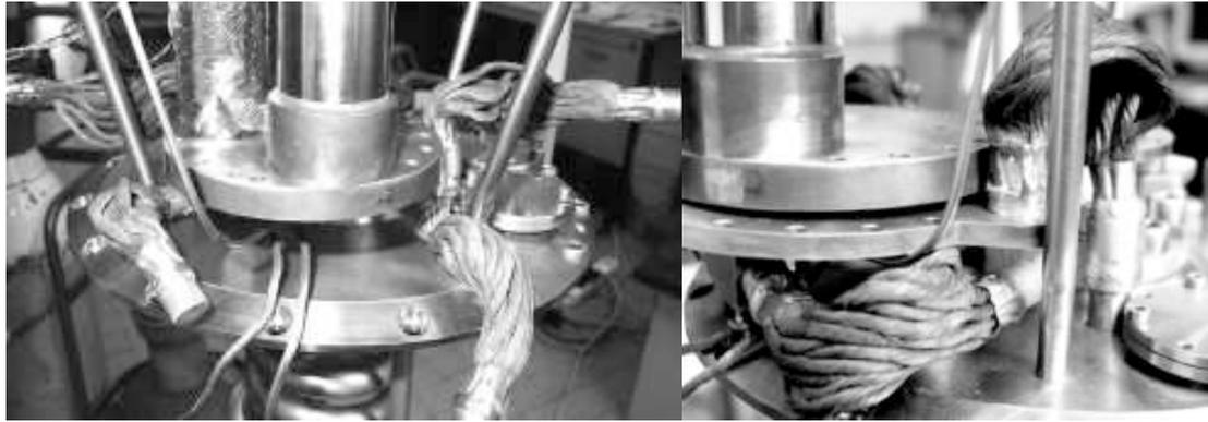
FIG. 4.23: Détails du raccordement par soudure étain des liens thermiques sur la bride de thermalisation au tube à gaz pulsé
