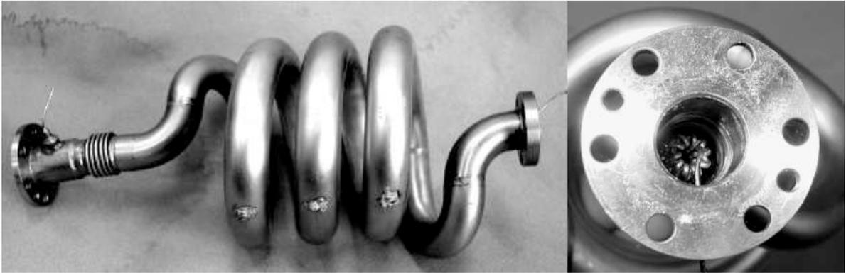
FIG. 5.2: COMO : Photos de l'échangeur spiralé
