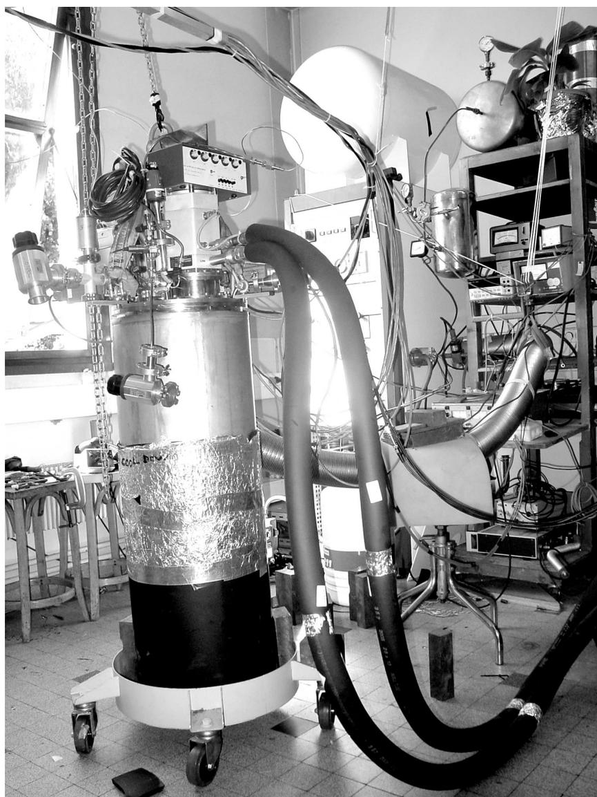
FIG. D.1: Vue d'ensemble du cryostat à dilution
