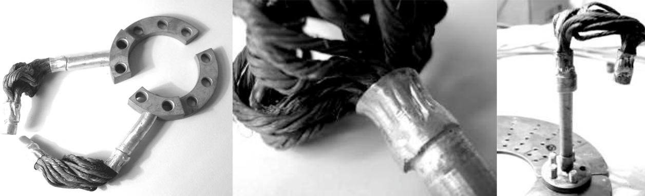
FIG. 4.22: Détails de la thermalisation du calorimètre, avec de gauche à droite : la thermalisation centrale de la bride, les connexions magnétoformées et brasées des tresses en cuivre et la thermalisation du disque 4 K
