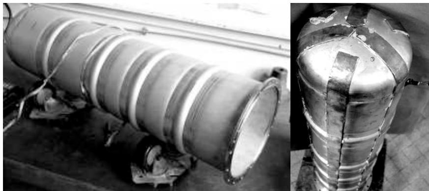
FIG. 4.20: Photo du calorimètre inox et de sa thermalisation cuivre
