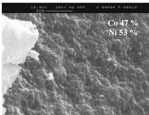
**Figure IV-31** : Images MEB de la phase solide intermédiaire plus dense de coloration kaki préparée avec 0,175 M d'hydroxyde de sodium et analyse EDX du cobalt et du nickel
