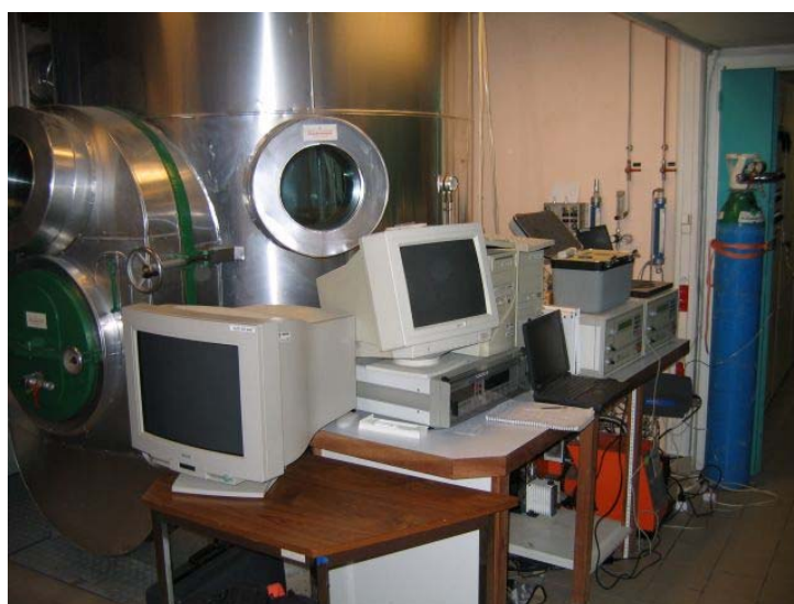
Figure II.1. Caisson hypobare utilisé au Centre de Recherche du Service de Santé des Armées (CRSSA, La Tronche, France) pour la calibration des analyseurs 2537A aux basses pressions.
