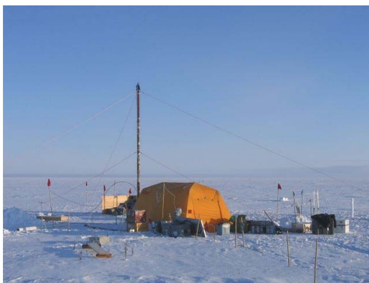
Figure II.4. Campement du forage de 100 mètres réalisé entre le 26 mai et le 1er juin 2006 à Summit, où l'air du névé a été échantillonné de la surface jusqu'au close-off pour, entre autres, l'analyse in situ de \text{Hg}^{\circ} .
